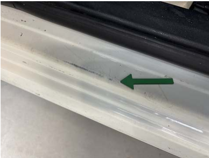
Schweller links (Kratzer)
