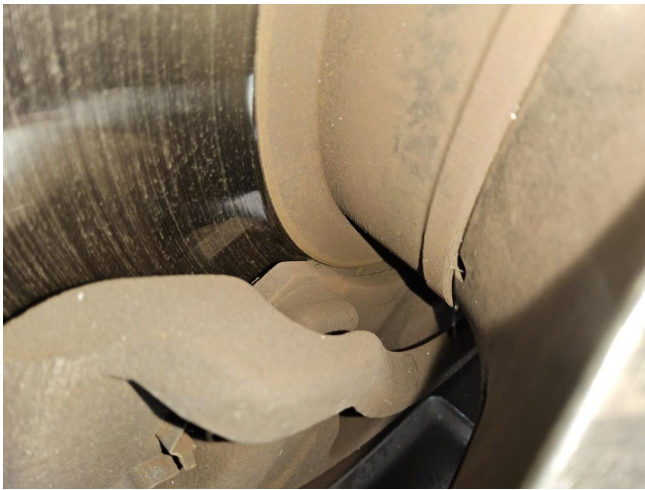
Bremsanlage - Verschleißmaß Bremse VA prüfen
