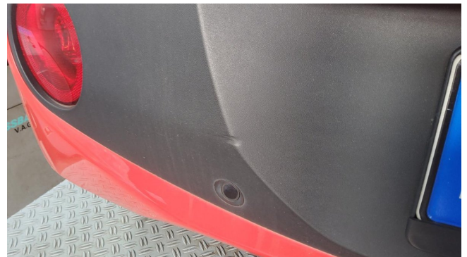
Stoßfänger H Abdeckung Mitte eingedrückt ern.
