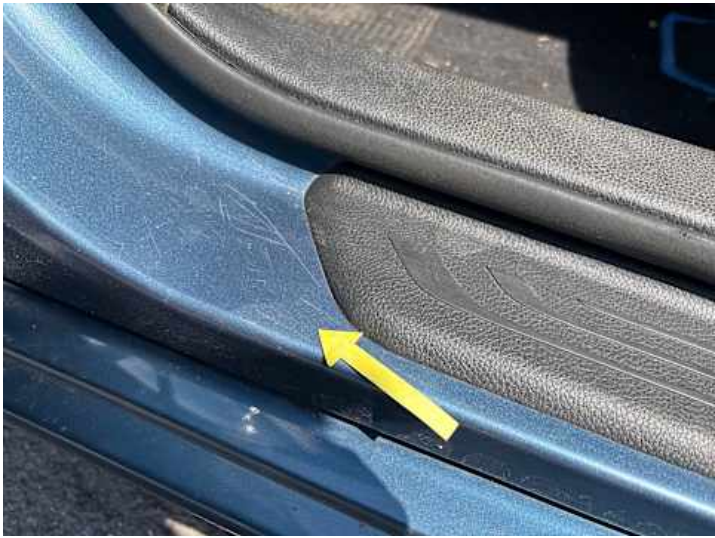
Schweller links (Kratzer)
