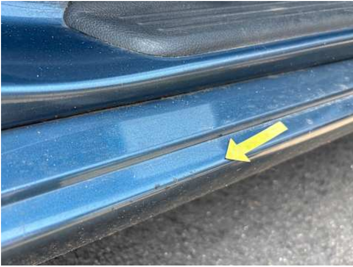
Schweller rechts (Kratzer, Lackschaden)
