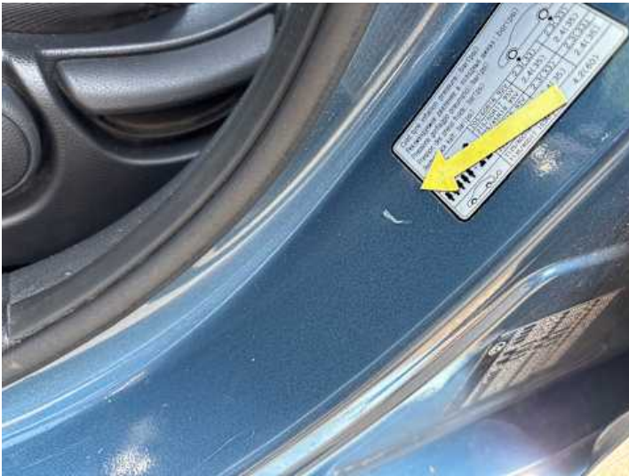
Fahrertür (Delle, Lackschaden)
