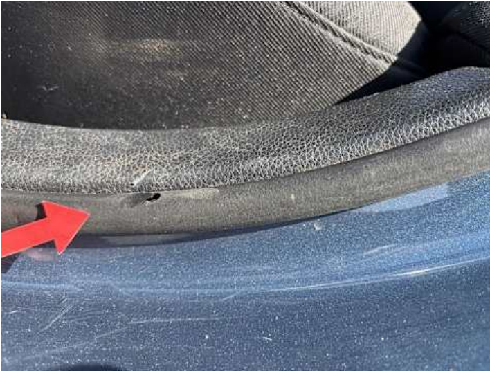
Türe hinten links (Riss/Bruch)
