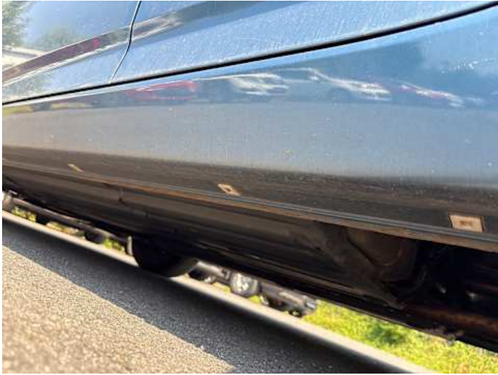
Schweller links (Rost)
