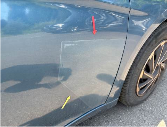
Kotflügel vorne rechts (Lackschaden, Unsachgemäß instand gesetzt)
