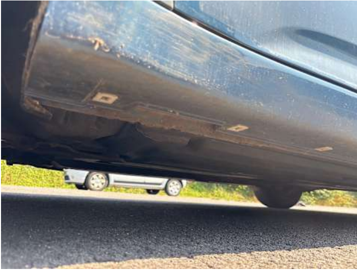
Schweller links (Rost)
