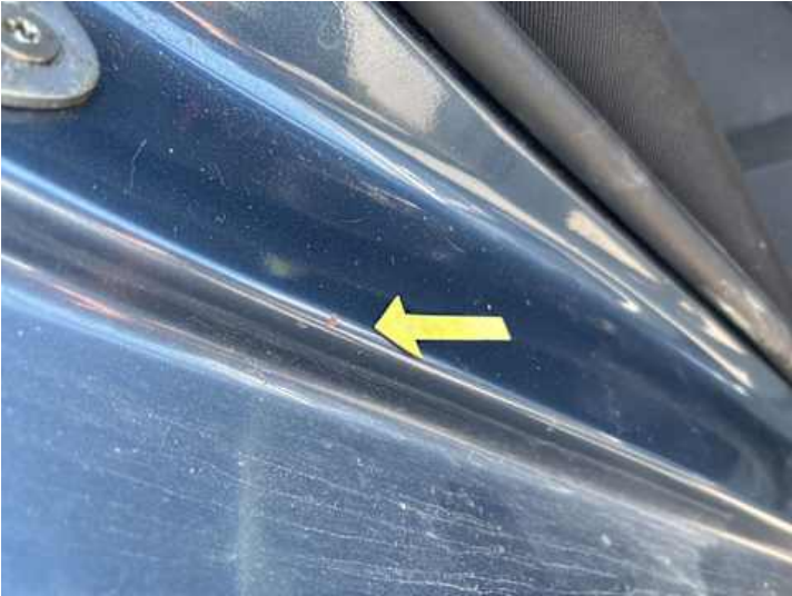
Türe hinten rechts (Rost, Lackschaden)
