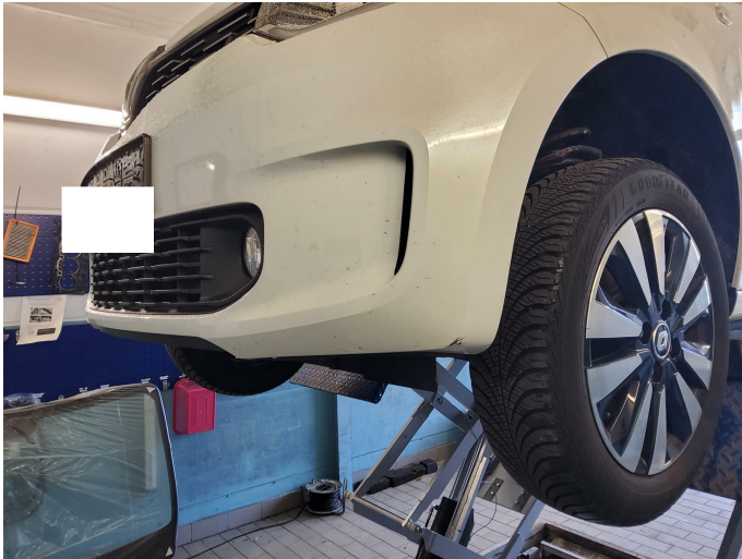
Bild 17: Außen, Stoßfänger vorne - Lackierung, verschrammt, lackieren mit Lackaufbau
