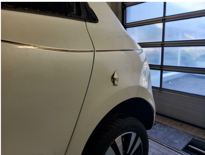
Bild 11: Außen, Seitenteil hinten links, eingedellt, Gebrauchsspur
