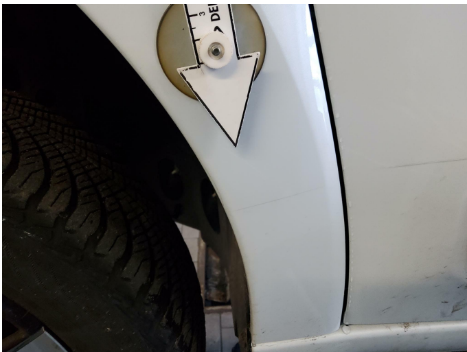
Bild 7: Außen, Kotflügel vorne links - Lackierung, verschrammt, polieren
