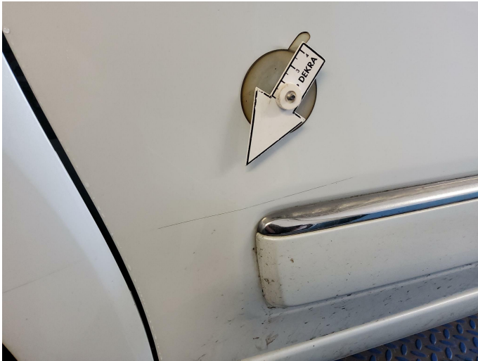
Bild 5: Außen, Tür vorne links - Lackierung, verschrammt, polieren
