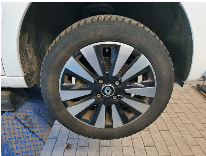
Bild 15: Außen, Felge vorne rechts - Glanzgedrehte Alufelge , zerkratzt, erneuern
