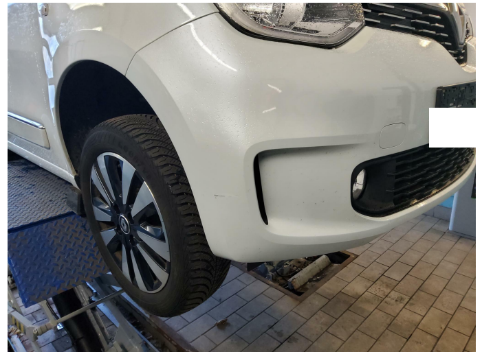
Bild 4: Außen, Stoßfänger vorne - Lackierung, verschrammt, lackieren mit Lackaufbau
