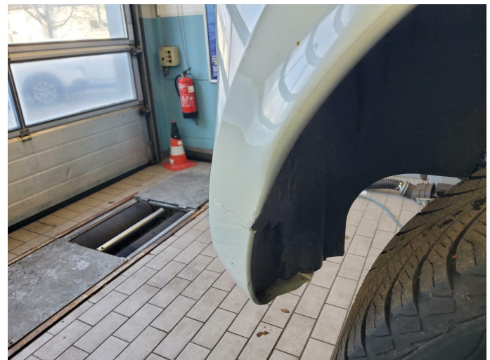
Bild 12: Außen, Stoßfänger hinten, deformiert, erneuern
