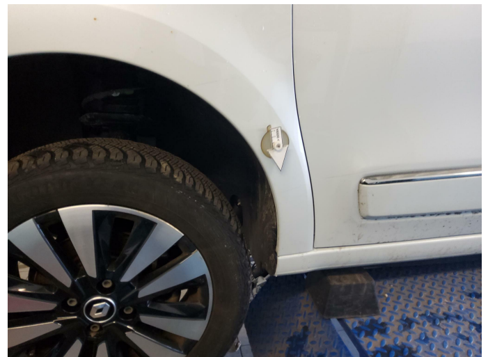
Bild 8: Außen, Kotflügel vorne links - Lackierung, verschrammt, polieren
