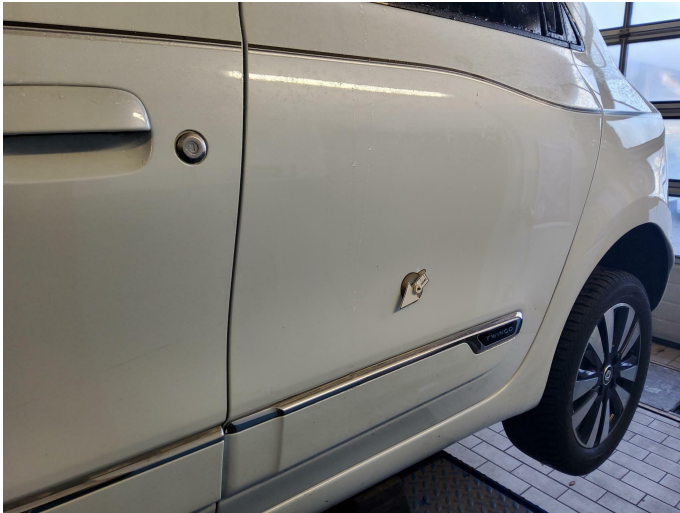
Bild 9: Außen, Tür hinten links, eingedellt, drücken
