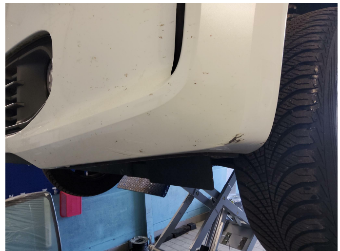
Bild 16: Außen, Stoßfänger vorne - Lackierung, verschrammt, lackieren mit Lackaufbau
