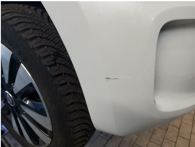
Bild 3: Außen, Stoßfänger vorne - Lackierung, verschrammt, lackieren mit Lackaufbau
