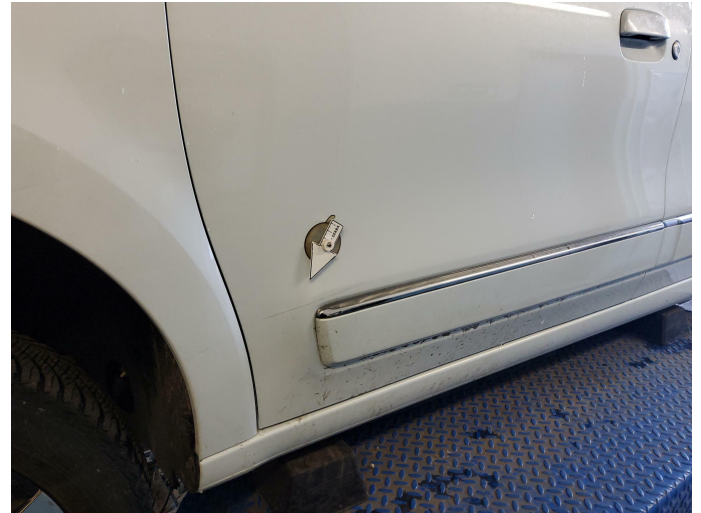
Bild 6: Außen, Tür vorne links - Lackierung, verschrammt, polieren
