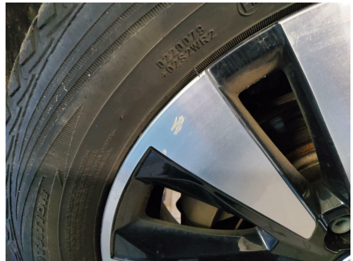
Bild 14: Außen, Felge vorne rechts - Glanzgedrehte Alufelge , zerkratzt, erneuern
