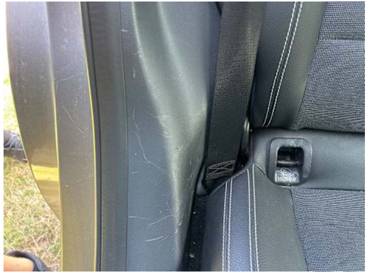
Innenraum (Kratzer, Verschleiß)
