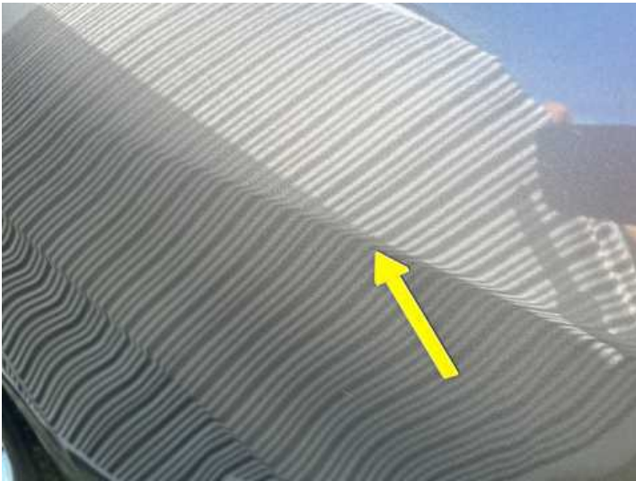
Türe hinten rechts (Delle, Kratzer)
