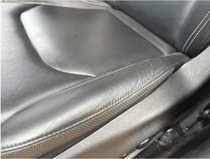
Innenraum (Verschmutzung, Verschleiß)
