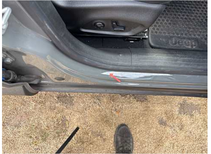
Schweller rechts (Kratzer)
