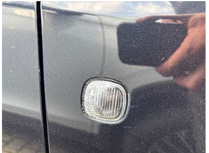
Kotflügel vorne rechts (Riss/Bruch)
