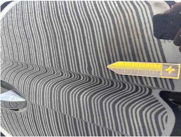
Türe hinten links (Delle)
