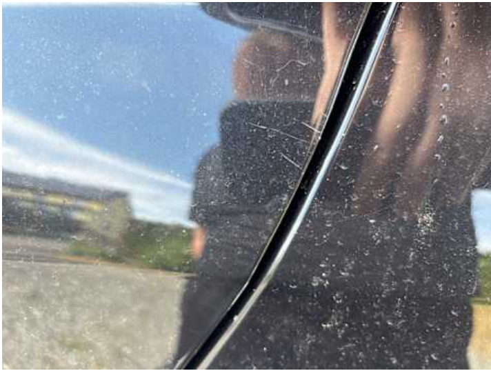
Türe hinten links (Kratzer)
