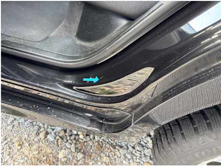
Schweller links (Kratzer)
