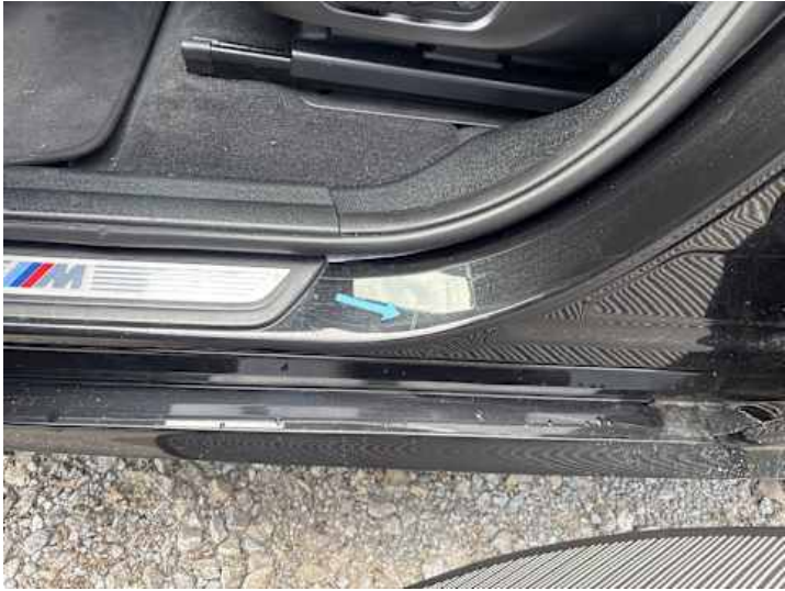
Schweller links (Kratzer)
