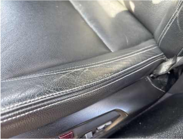
Innenraum (Verschmutzung, Verschleiß)
