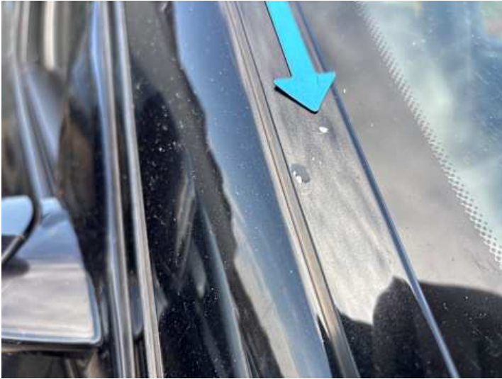
Windschutzscheibe (Anderer Schaden): Lasckschaden Windlauf
