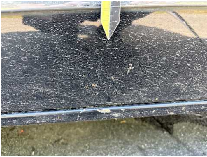
Schweller rechts (Kratzer, Lackschaden)
