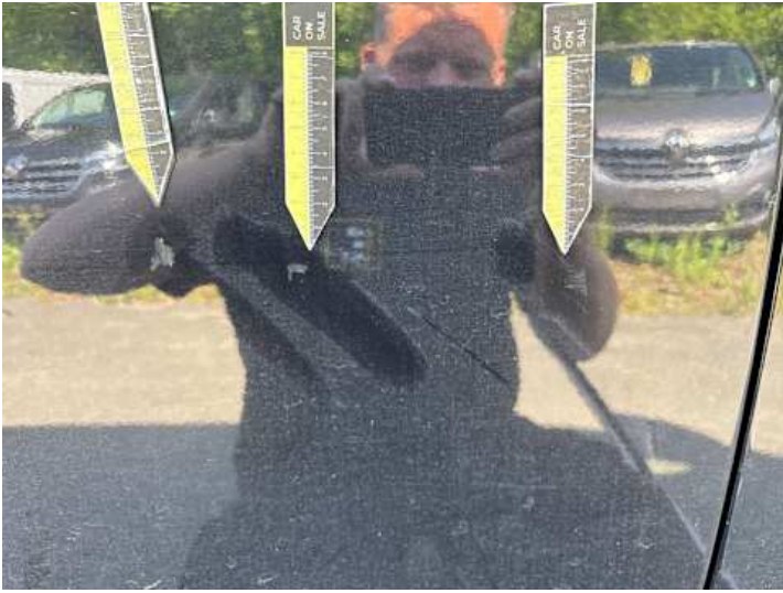
Türe hinten rechts (Kratzer, Unsachgemäß instand gesetzt)
