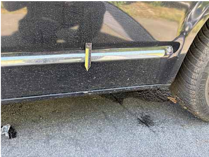
Schweller rechts (Kratzer, Lackschaden)
