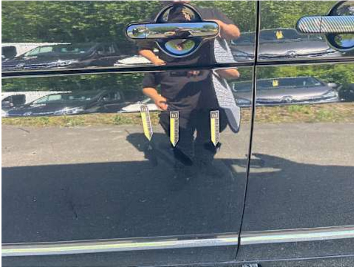
Türe hinten rechts (Kratzer, Unsachgemäß instand gesetzt)
