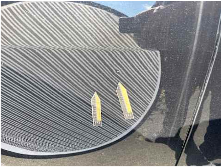
Türe hinten links (Delle)
