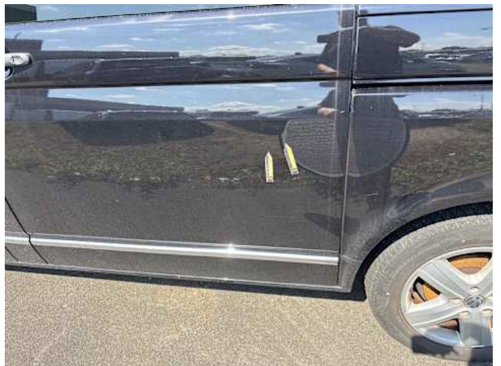
Türe hinten links (Delle)
