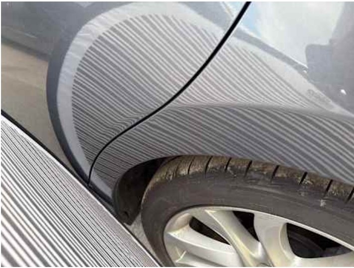
Seitenteil hinten links (Delle)
