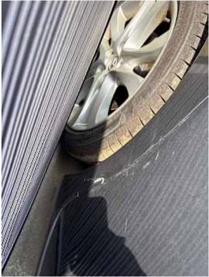
Seitenteil hinten rechts (Delle)
