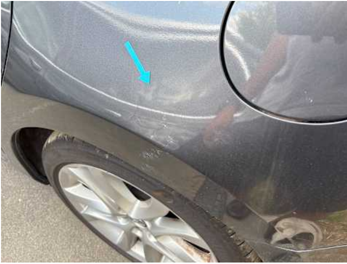
Seitenteil hinten links (Kratzer)
