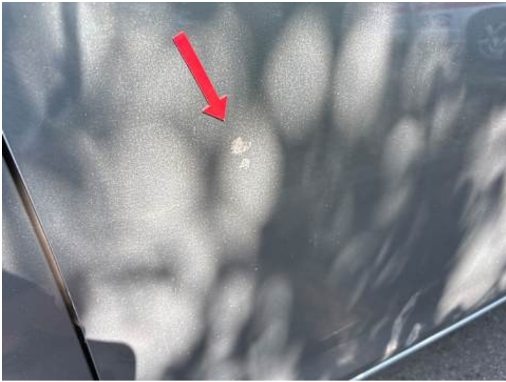
Beifahrertür (Unsachgemäß instand gesetzt)
