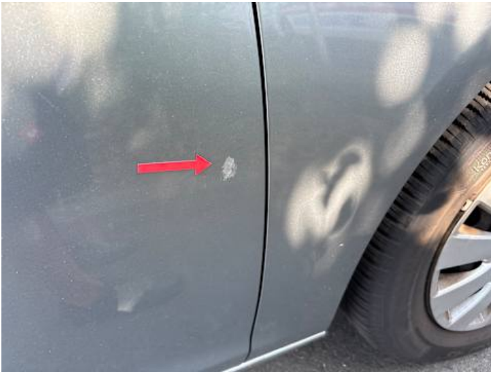
Beifahrertür (Unsachgemäß instand gesetzt)
