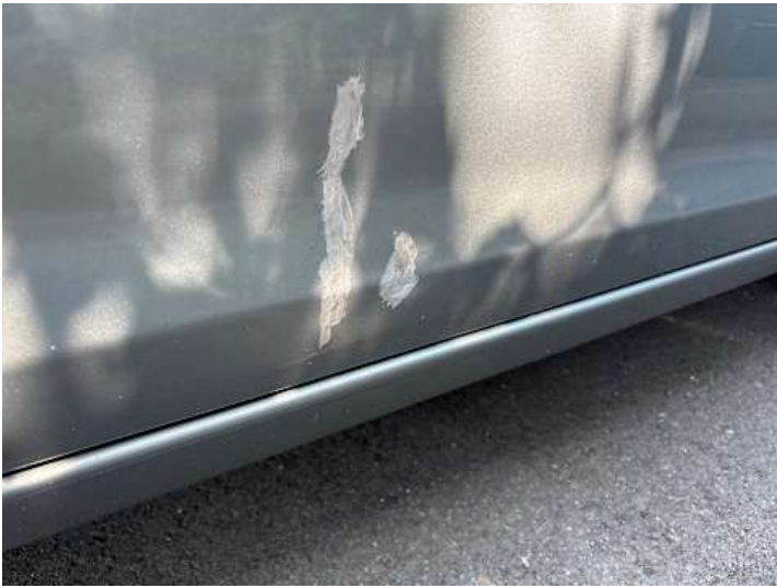
Beifahrertür (Unsachgemäß instand gesetzt)
