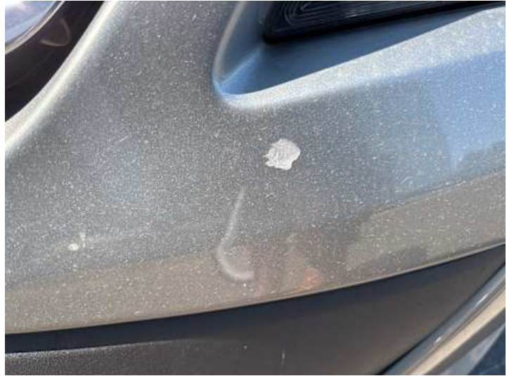
Stoßstange vorne (Unsachgemäß instand gesetzt)
