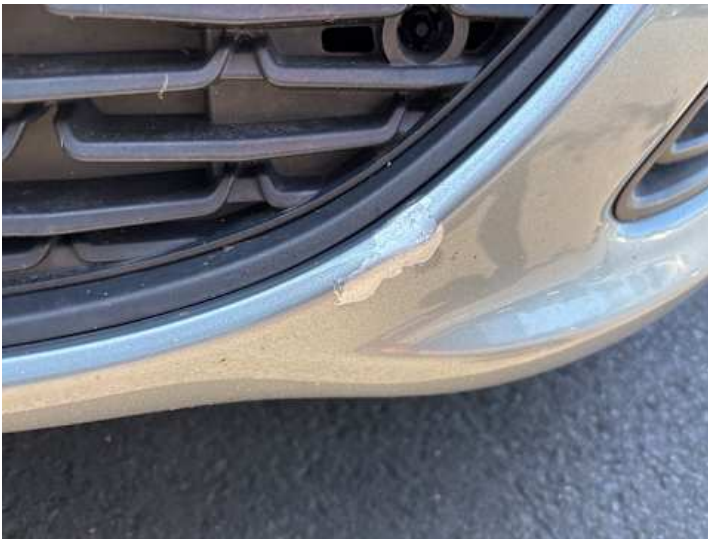
Stoßstange vorne (Unsachgemäß instand gesetzt)
