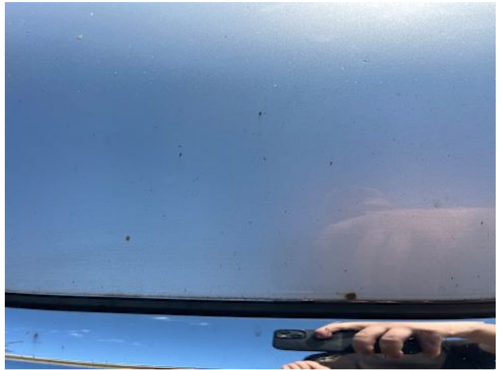
Motorhaube (Lackschaden, Rost, Steinschlag)
