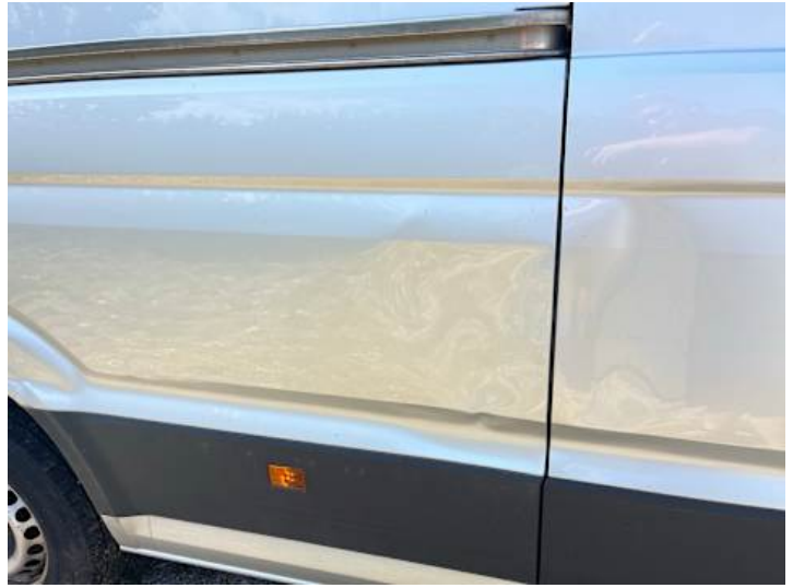
Seitenteil hinten rechts (Kratzer, Verformung)
