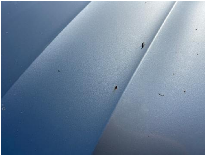
Motorhaube (Lackschaden, Rost, Steinschlag)
