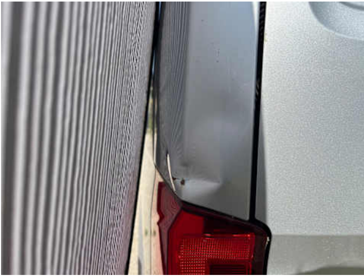
Seitenteil hinten links (Lackschaden, Rost, Verformung)
