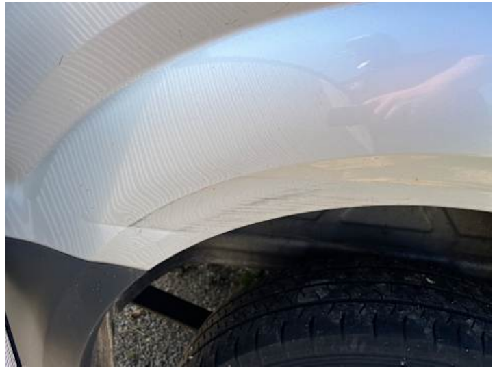
Seitenteil hinten rechts (Kratzer, Verformung)
