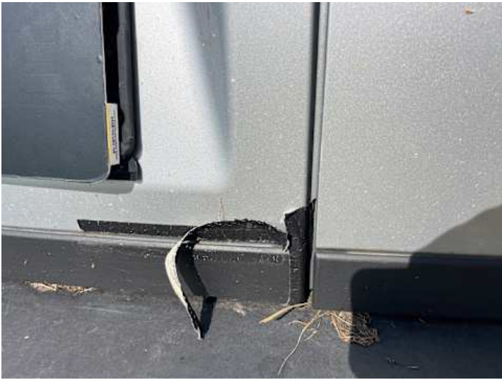
Heckklappe (Delle, Lackschaden, Unsachgemäß instand gesetzt)
