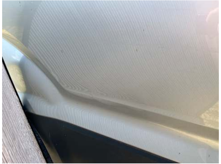
Seitenteil hinten rechts (Kratzer, Verformung)
