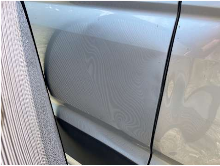
Seitenteil hinten rechts (Kratzer, Verformung)
