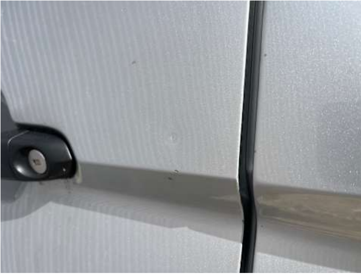
Fahrtür (Delle, Lackschaden)
