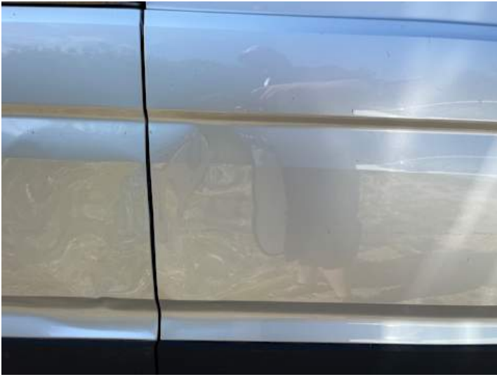
Türe hinten rechts (Verformung, Kratzer)
