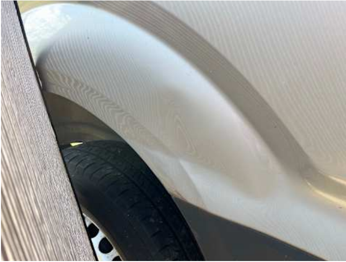
Seitenteil hinten rechts (Kratzer, Verformung)
