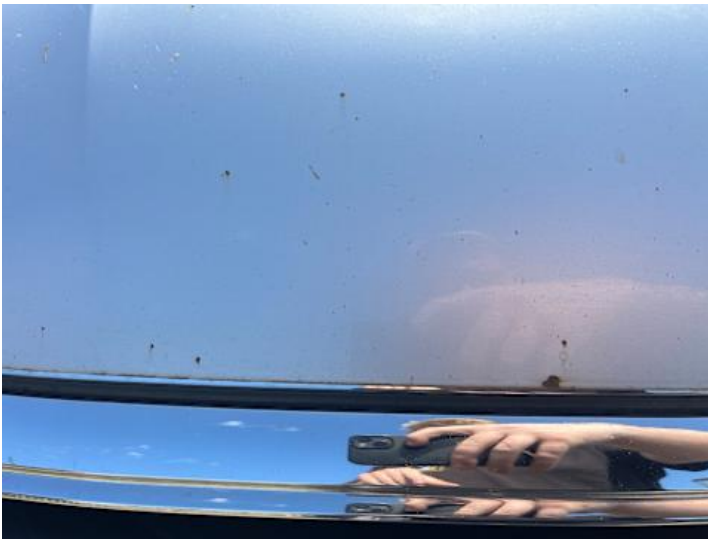
Motorhaube (Lackschaden, Rost, Steinschlag)
