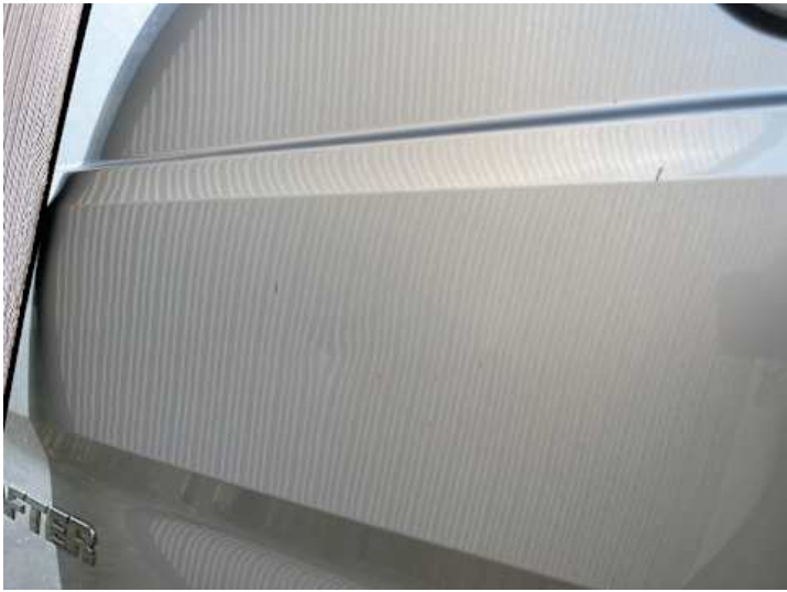
Heckklappe (Delle, Lackschaden, Unsachgemäß instand gesetzt)
