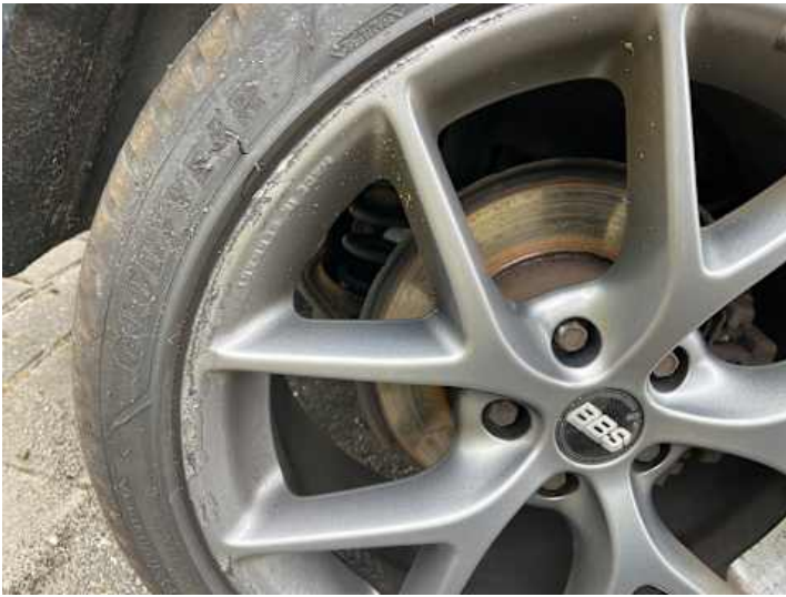
Rad (Kratzer, Anderer Schaden): Flankenschaden.
