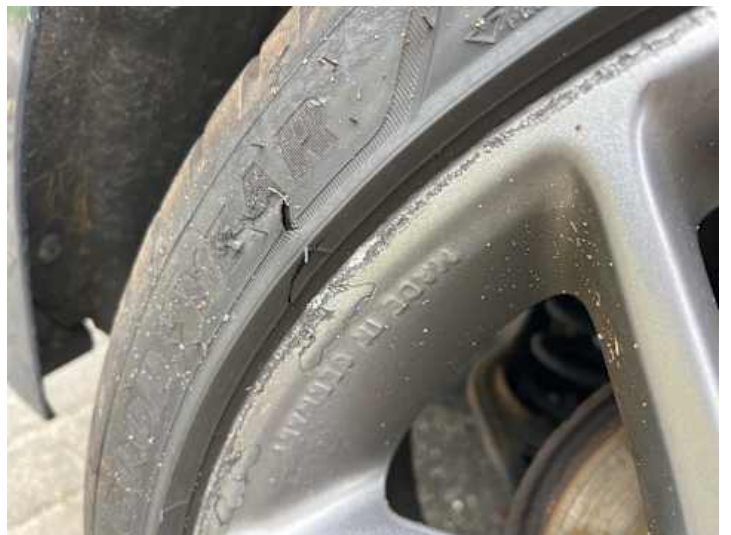
Rad (Kratzer, Anderer Schaden): Flankenschaden.
