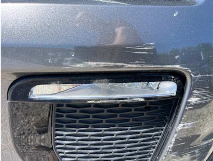
Stoßstange vorne (Kratzer, Lackschaden, Spaltmaße ungenau, Verformung)
