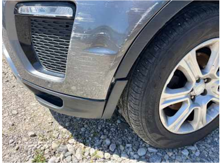
Stoßstange vorne (Kratzer, Lackschaden, Spaltmaße ungenau, Verformung)
