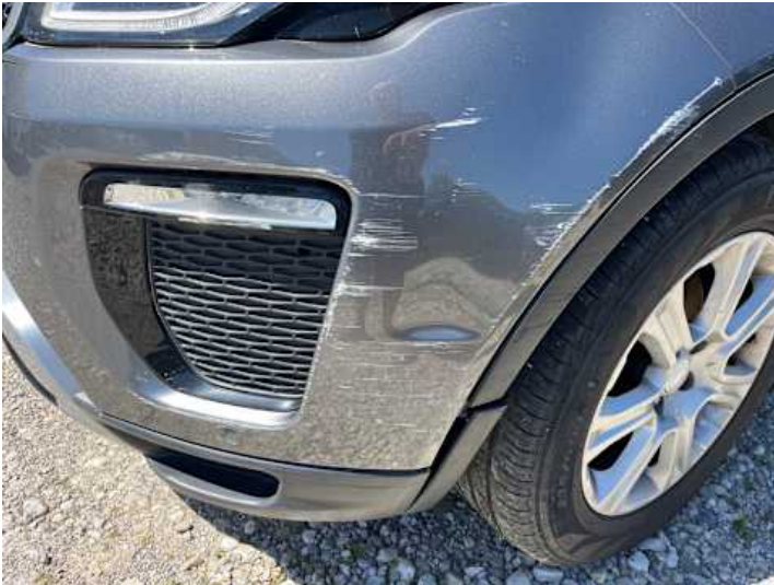
Stoßstange vorne (Kratzer, Lackschaden, Spaltmaße ungenau, Verformung)
