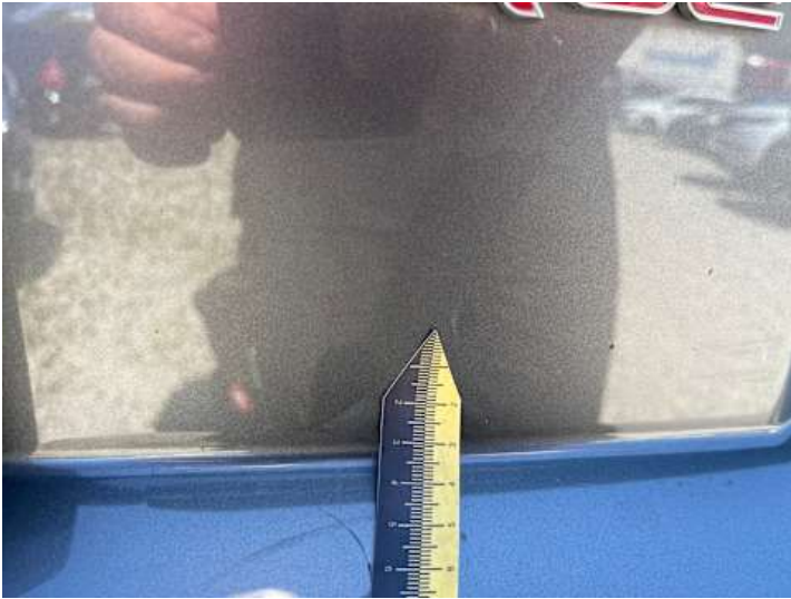
Heckklappe (Kratzer, Lackschaden)
