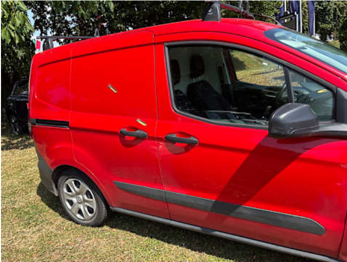
Türe hinten rechts (Kratzer, Delle, Lackschaden)
