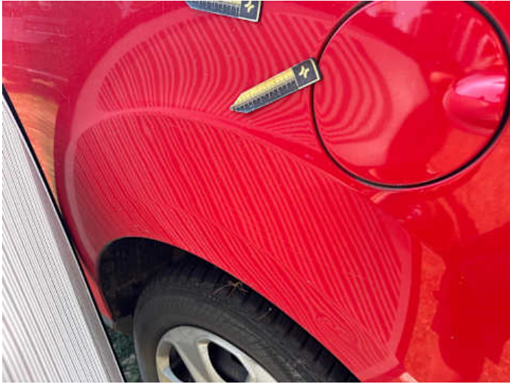
Seitenteil hinten links (Delle, Lackschaden)
