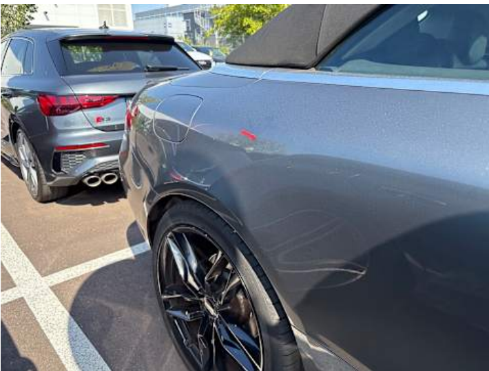
Seitenteil hinten rechts (Delle)
