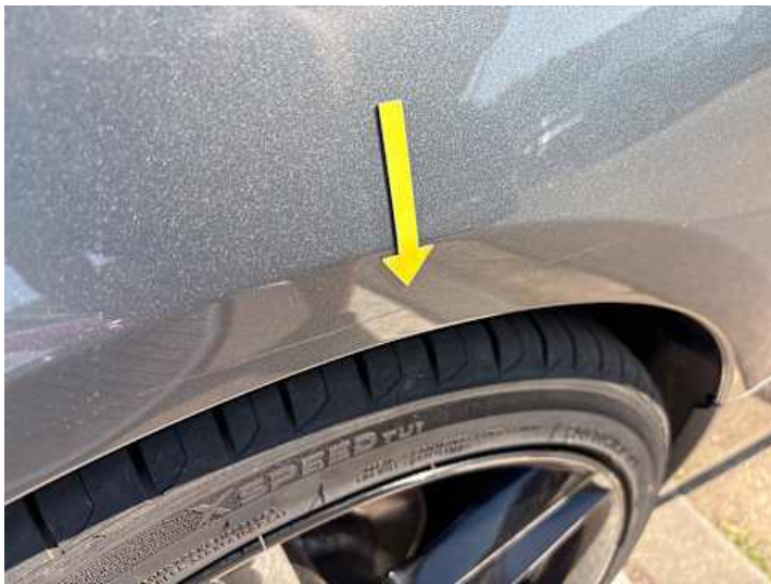
Seitenteil hinten rechts (Lackschaden)
