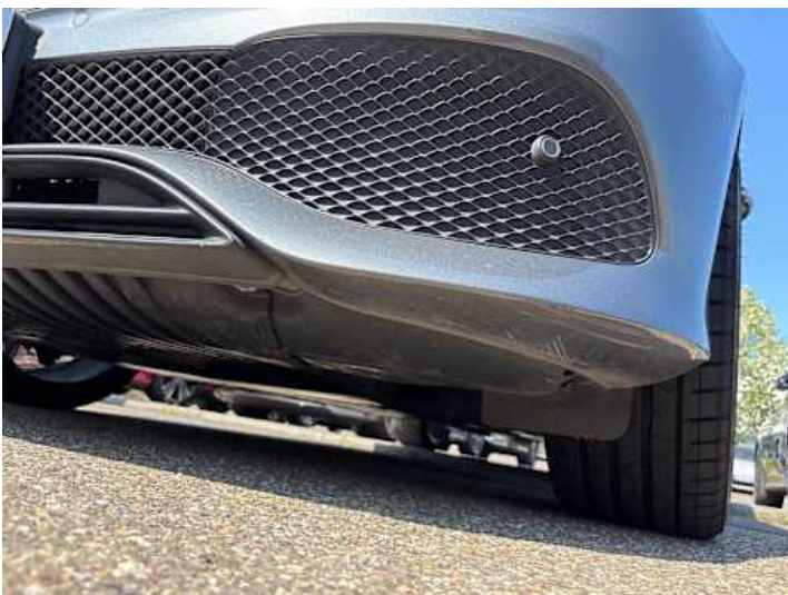
Stoßstange vorne (Lackschaden)
