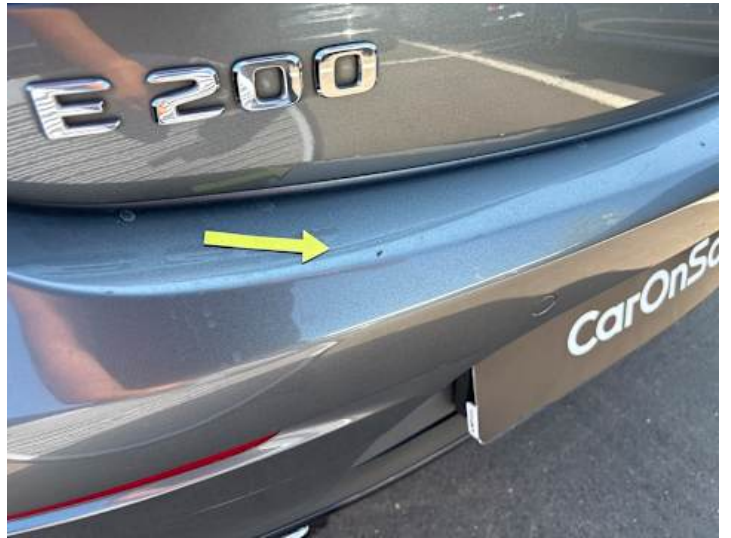
Stoßstange hinten (Lackschaden)
