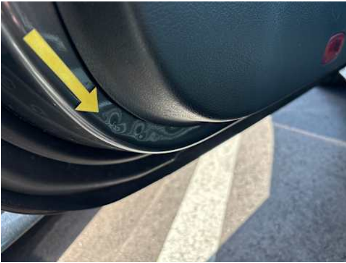
Fahrtür (Delle, Lackschaden)
