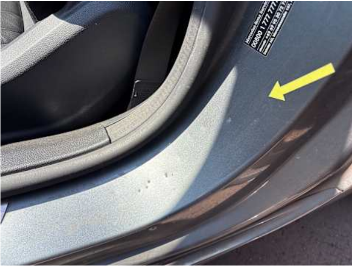
Schweller links (Lackschaden, Delle)
