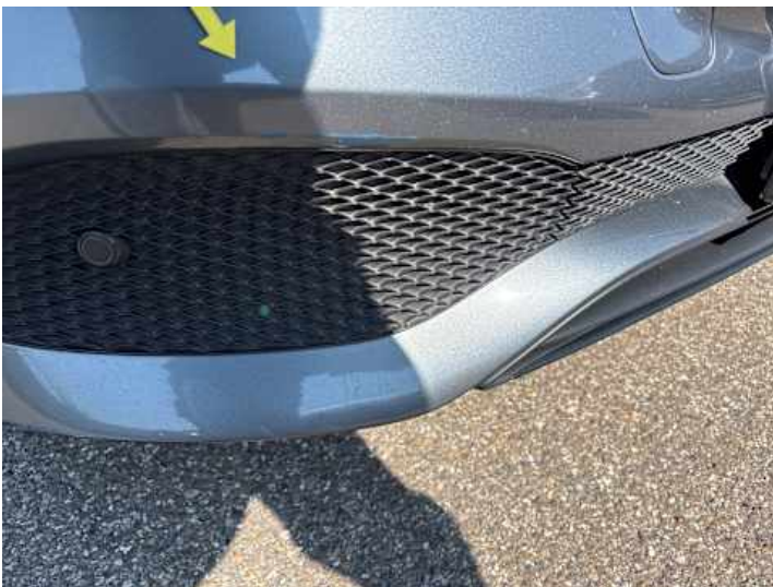
Stoßstange vorne (Lackschaden)
