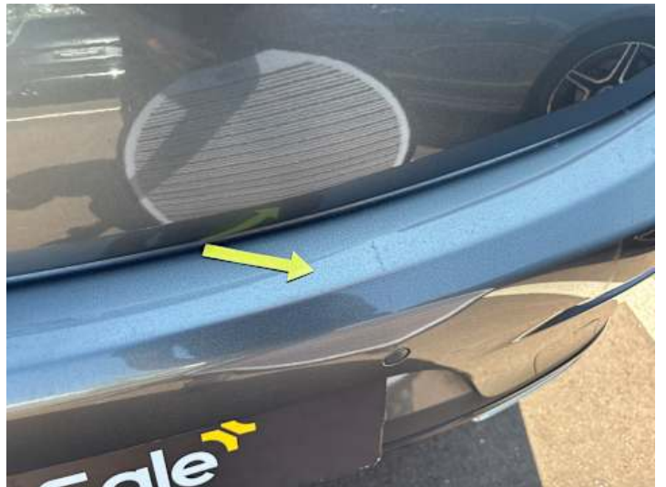
Stoßstange hinten (Lackschaden)
