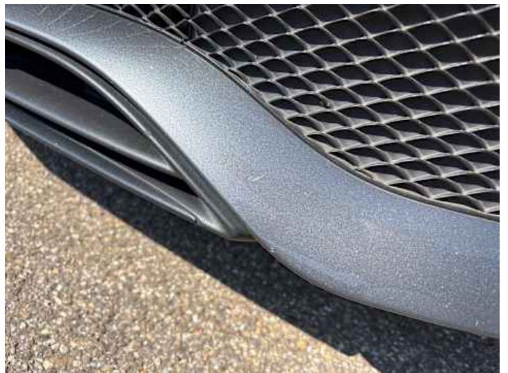
Stoßstange vorne (Lackschaden)
