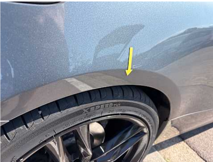
Seitenteil hinten rechts (Lackschaden)
