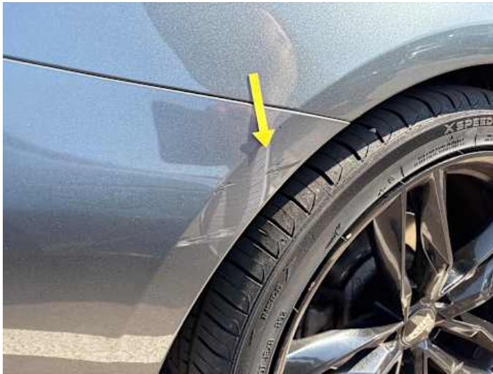
Stoßstange hinten (Lackschaden)
