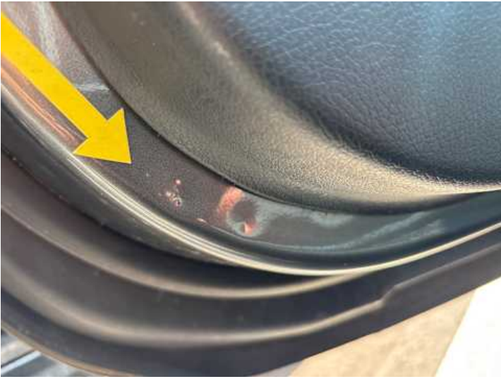
Fahrtür (Delle, Lackschaden)
