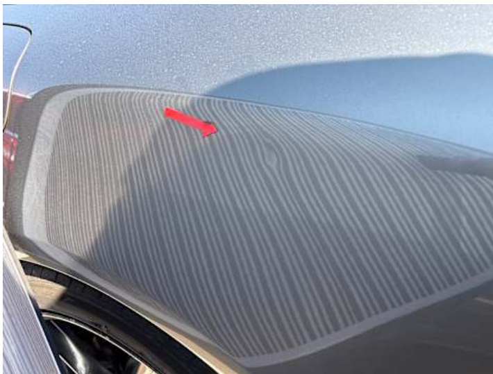
Seitenteil hinten rechts (Delle)
