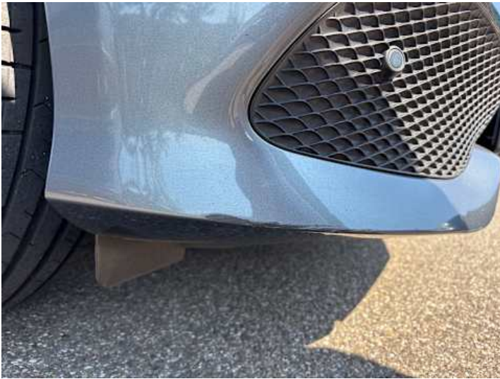
Stoßstange vorne (Lackschaden)
