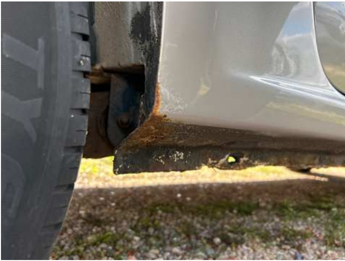
Schweller rechts (Kratzer, Rost)
