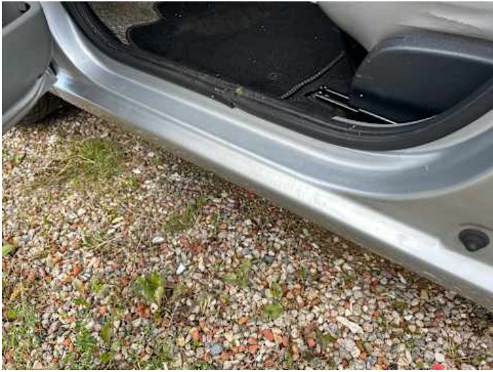
Schweller links (Kratzer)
