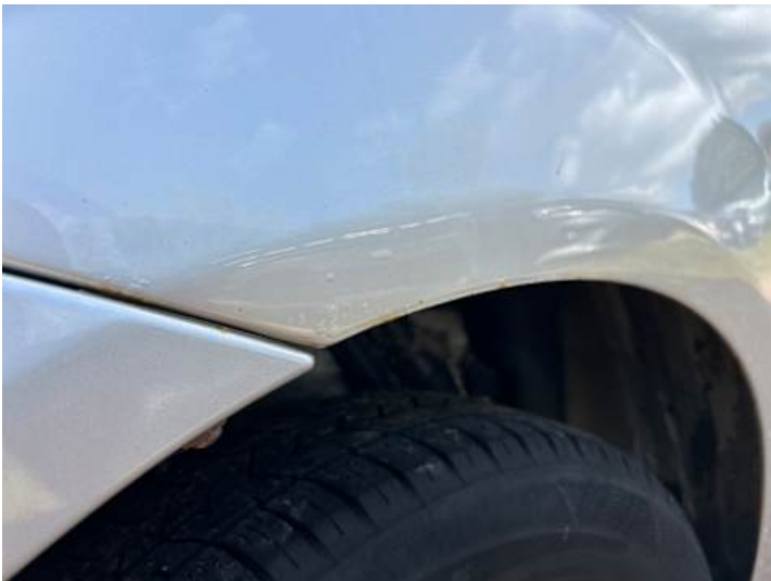
Seitenteil hinten rechts (Kratzer)
