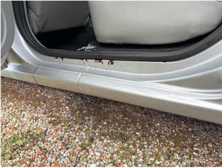
Schweller links (Kratzer)
