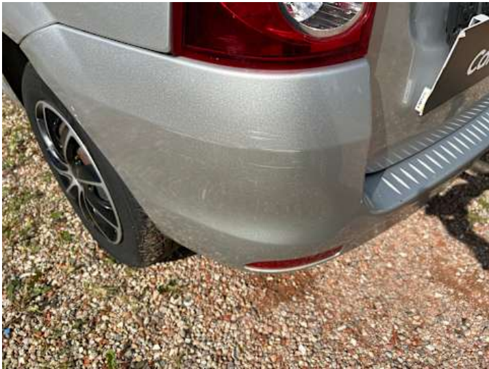
Stoßstange hinten (Kratzer)
