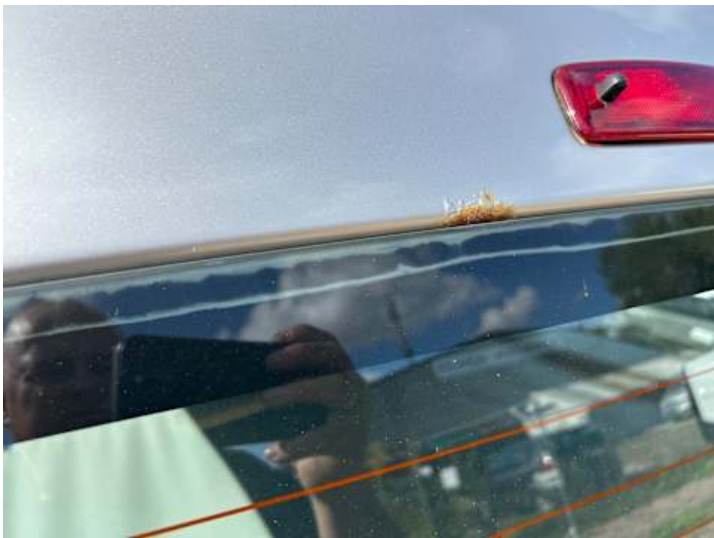
Rückscheibe (Anderer Schaden): Ablösung
