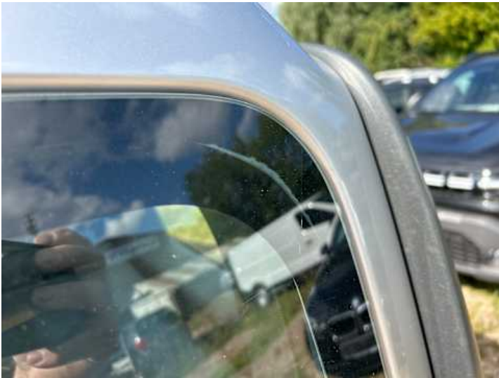
Rückscheibe (Anderer Schaden): Ablösung
