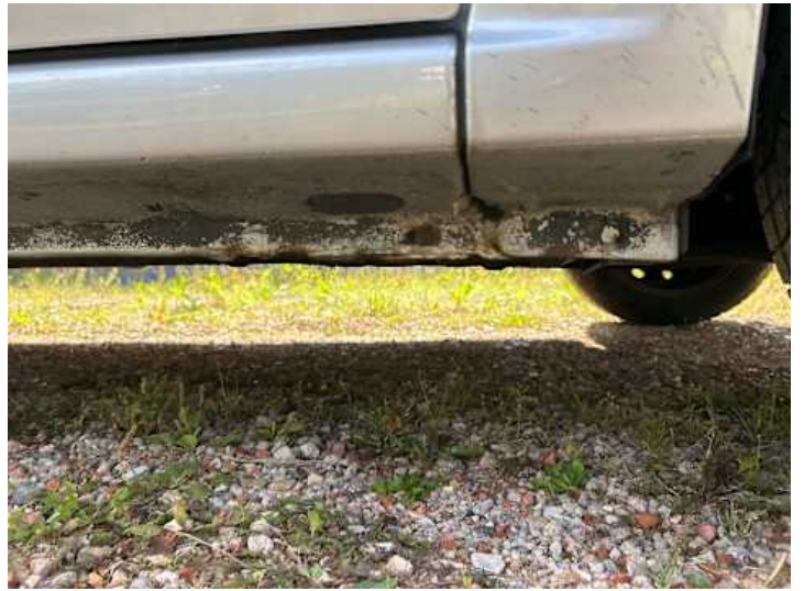
Schweller rechts (Kratzer, Rost)
