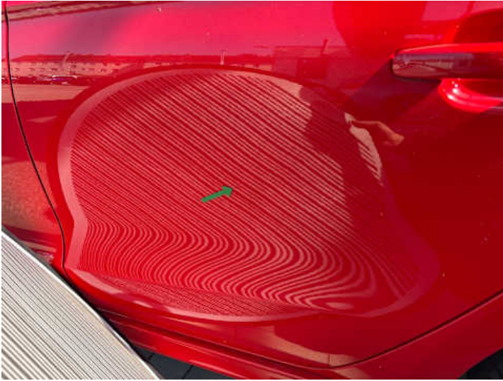
Türe hinten links (Delle)
