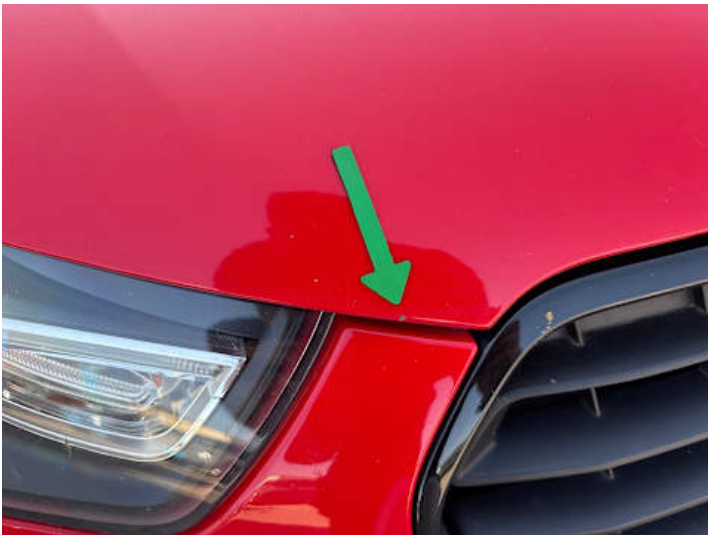
Motorhaube (Steinschlag, Rost)
