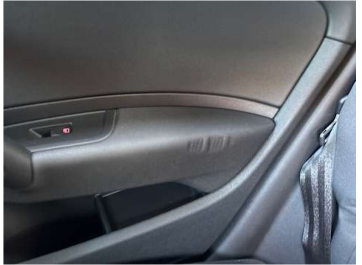
Innenraum (Anderer Schaden): Verformung
