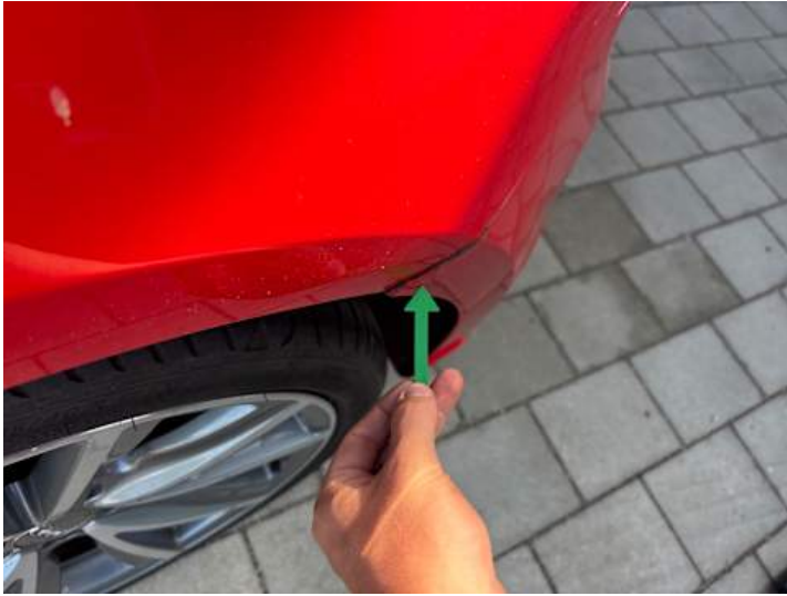
Stoßstange hinten (Spaltmaße ungenau)
