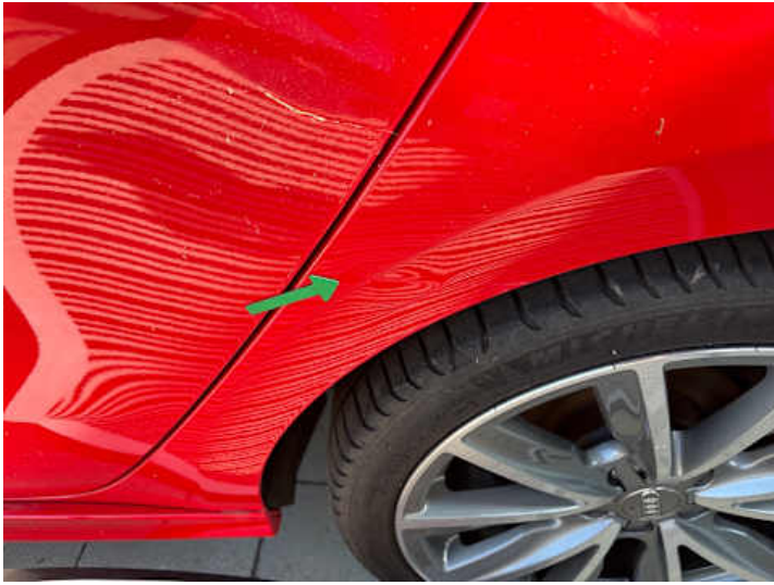
Seitenteil hinten links (Kratzer, Delle)
