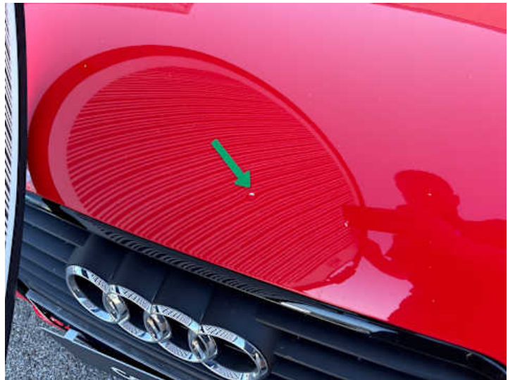
Motorhaube (Delle, Lackschaden)
