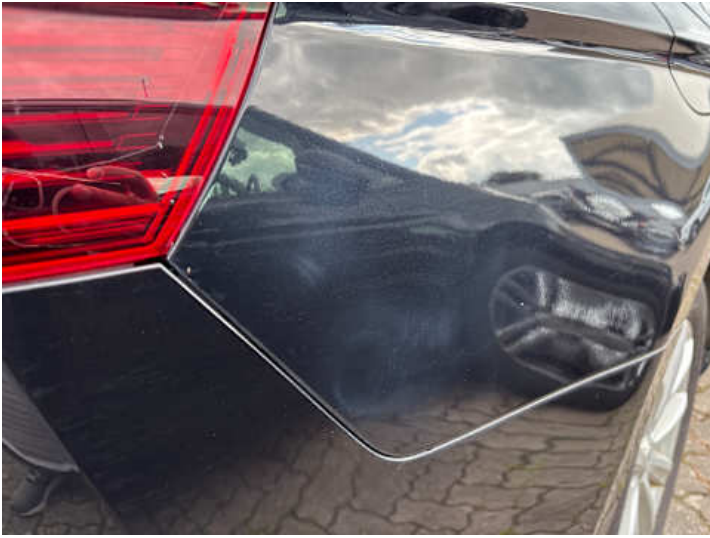
Seitenteil hinten rechts (Ausgeblichen/Matt)
