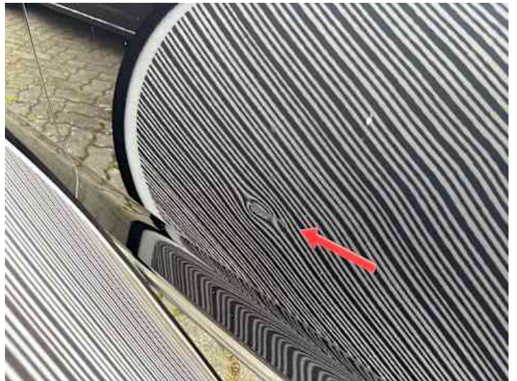
Beifahrertür (Lackschaden, Delle)
