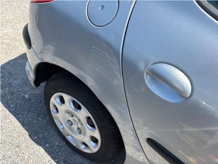
Seitenteil hinten rechts (Kratzer, Verformung)
