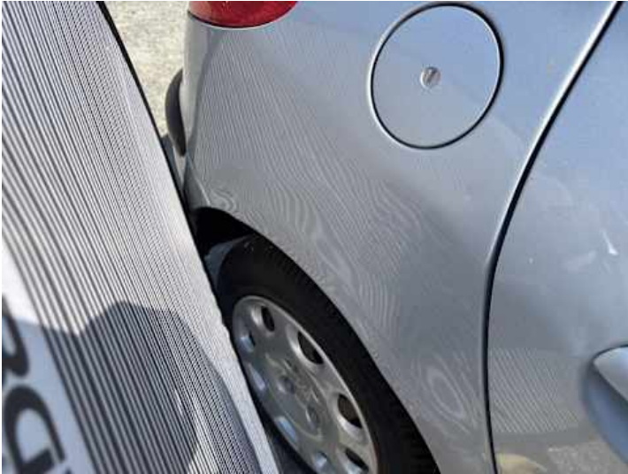
Seitenteil hinten rechts (Kratzer, Verformung)
