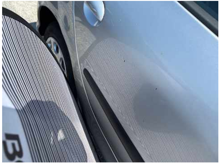
Türe hinten rechts (Kratzer, Verformung)
