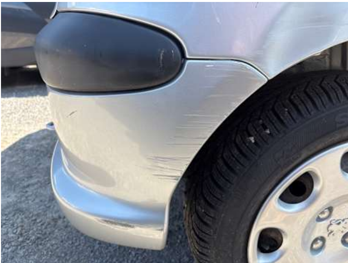
Stoßstange hinten (Kratzer, Riss/Bruch)
