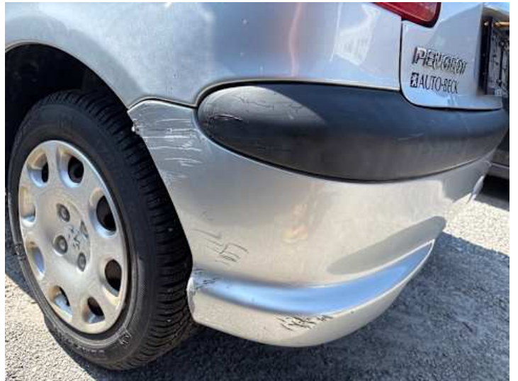
Stoßstange hinten (Kratzer, Riss/Bruch)
