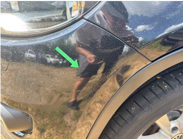
Stoßstange vorne (Unsachgemäß instand gesetzt)
