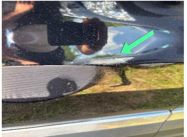
Fahrtür (Unsachgemäß instand gesetzt)
