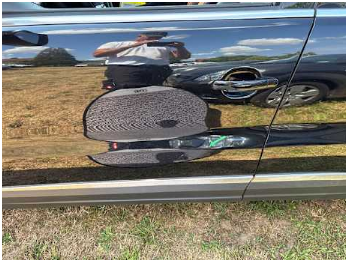
Fahrtür (Unsachgemäß instand gesetzt)
