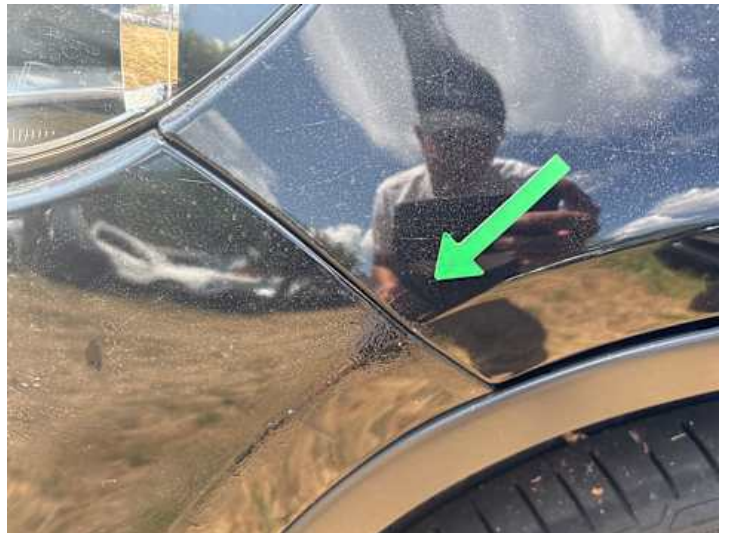
Kotflügel vorne links (Unsachgemäß instand gesetzt)
