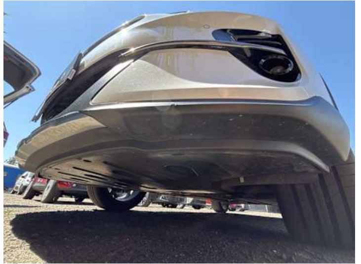
Stoßstange vorne (Kratzer, Verformung)
