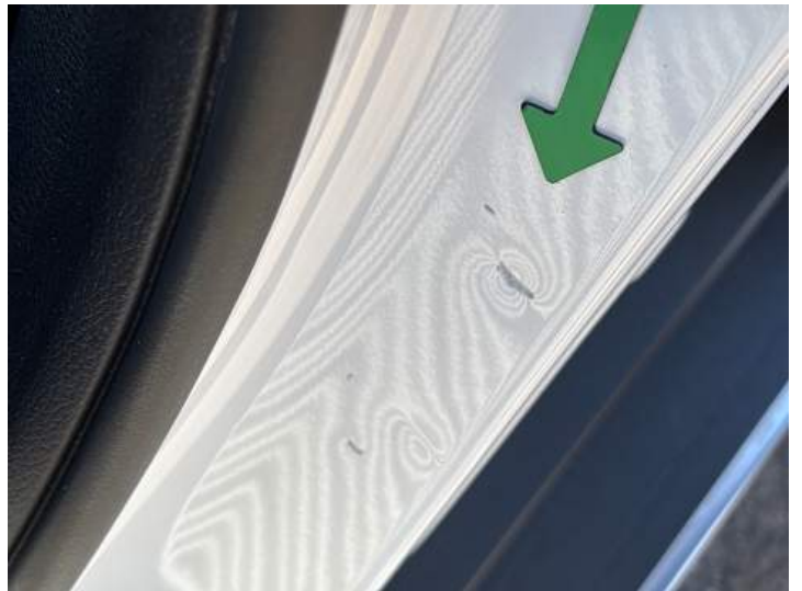
Schweller links (Kratzer, Delle)
