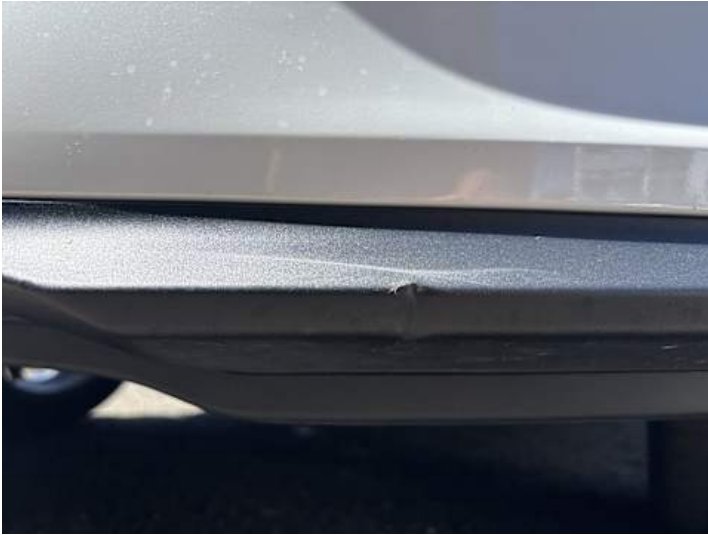
Stoßstange vorne (Kratzer, Verformung)
