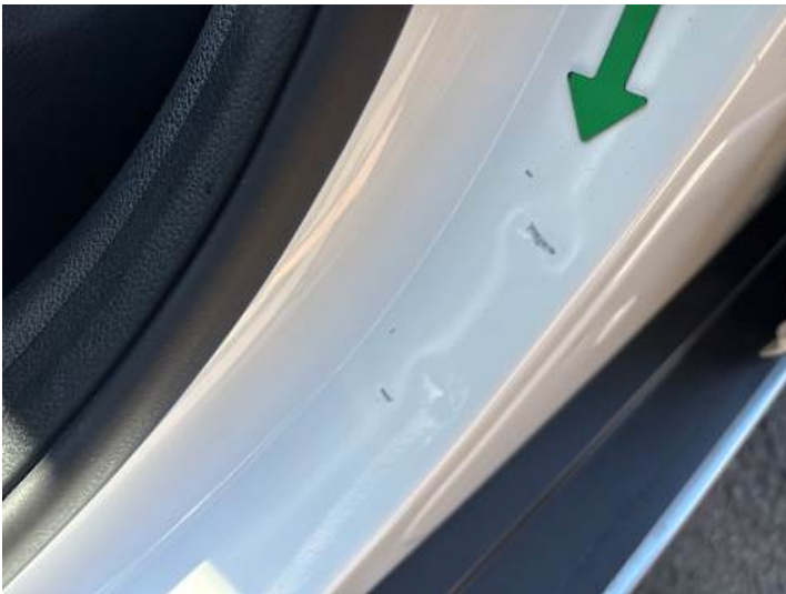
Schweller links (Kratzer, Delle)
