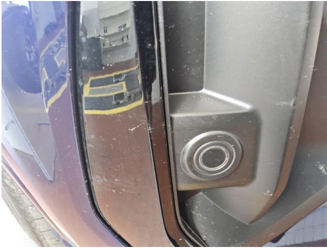
Stoßfänger vorne Rammschutzleiste rechts, zerkratzt, Gebrauchsspur (DEKRA)
