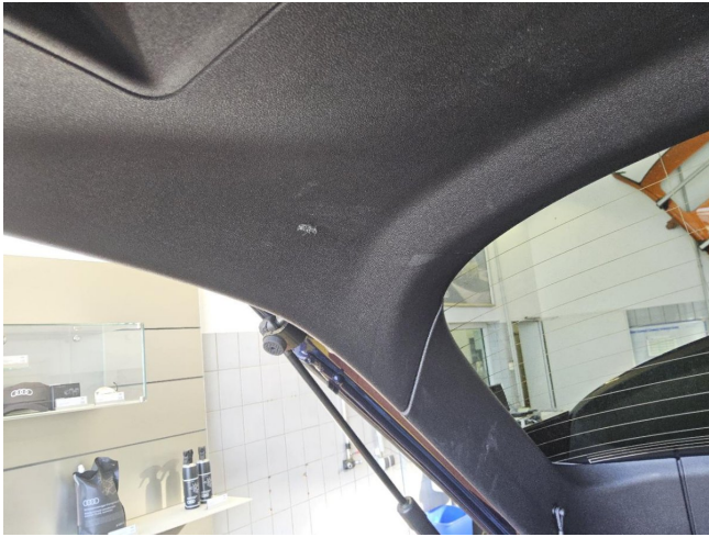
Heckklappenverkleidung verkratzt (DEKRA)
