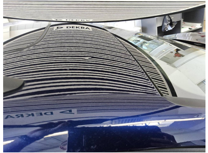
Dach, mehrfach eingedellt, drücken (DEKRA)
