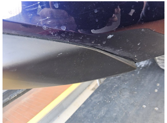
Anfahrschaden hinten rechts (DEKRA)
