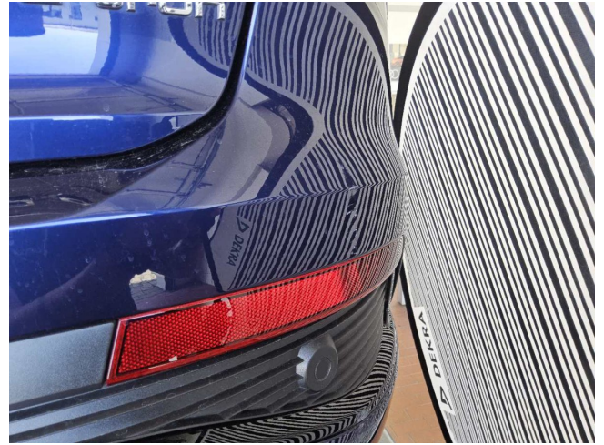
Anfahrschaden hinten rechts (DEKRA)
