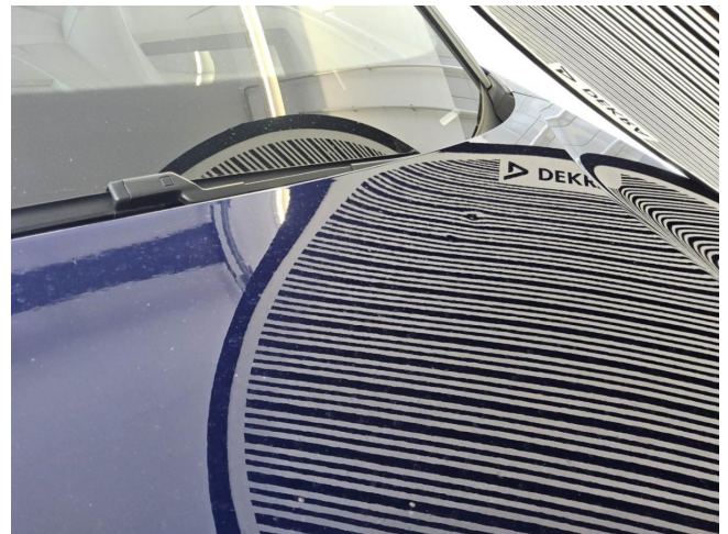
Motorhaube, deformiert, instandsetzen und lackieren mit Lackaufbau (DEKRA)
