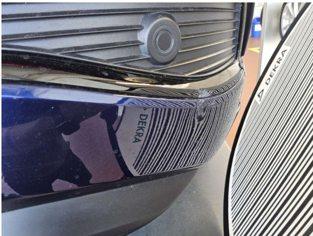
Anfahrschaden hinten rechts (DEKRA)
