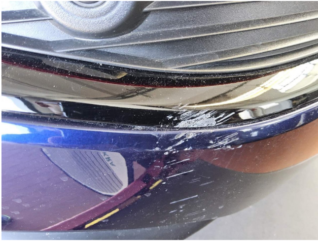
Anfahrschaden hinten rechts (DEKRA)
