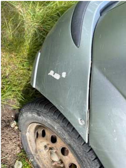
Stoßstange hinten (Riss/Bruch, Lackschaden)
