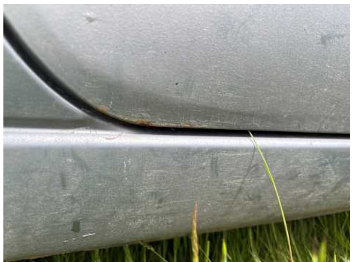
Beifahrtür (Rost, Riss/Bruch)
