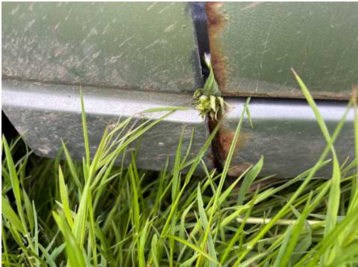
Kotflügel vorne links (Rost)
