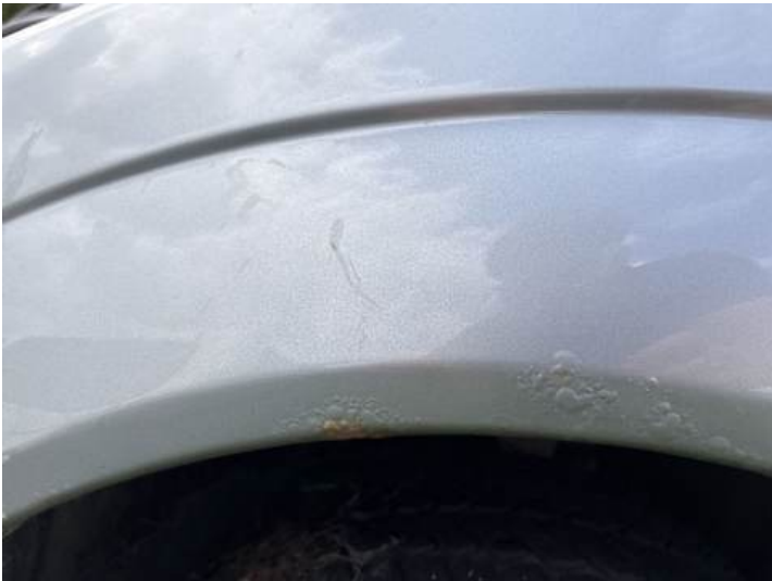
Kotflügel vorne links (Rost)
