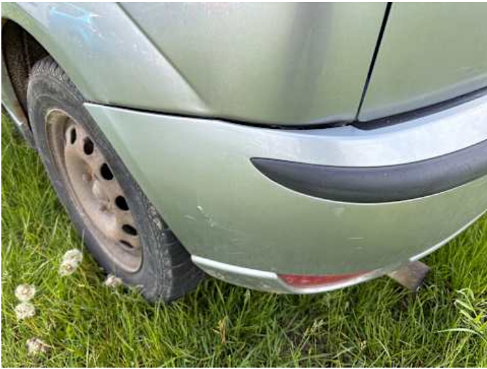
Stoßstange hinten (Riss/Bruch, Lackschaden)
