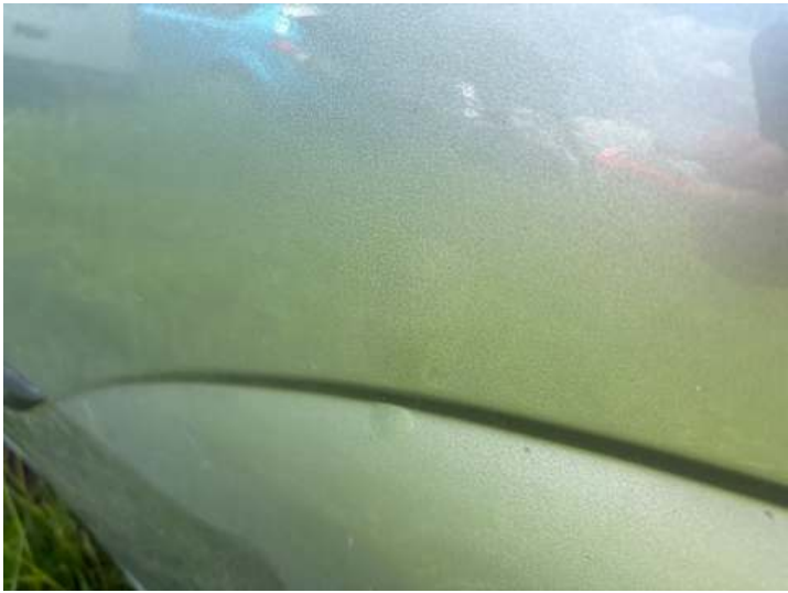
Seitenteil hinten links (Lackschaden)
