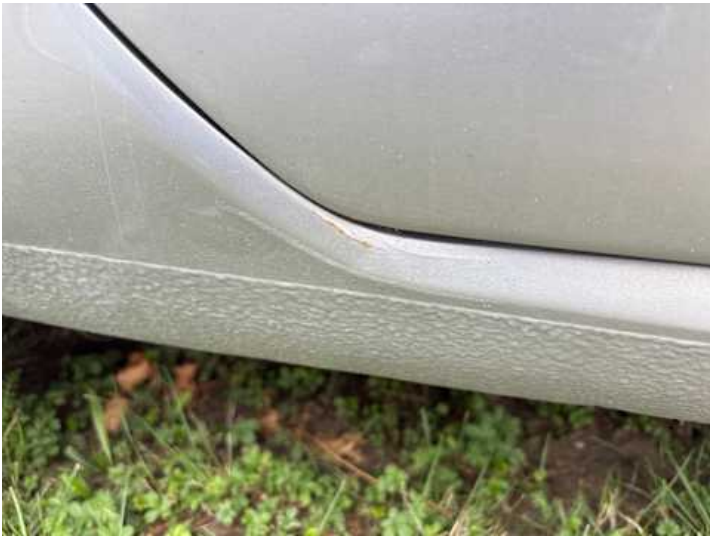
Schweller rechts (Rost, Unsachgemäß instand gesetzt)
