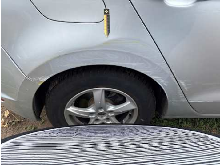
Seitenteil hinten rechts (Verformung, Lackschaden)
