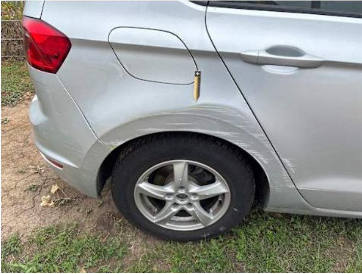
Seitenteil hinten rechts (Verformung, Lackschaden)
