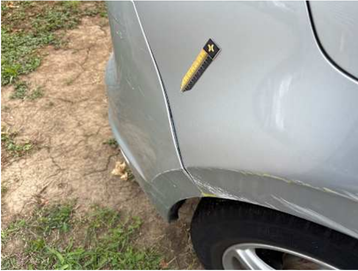
Stoßstange hinten (Lackschaden, Kratzer, Spaltmaße ungenau)
