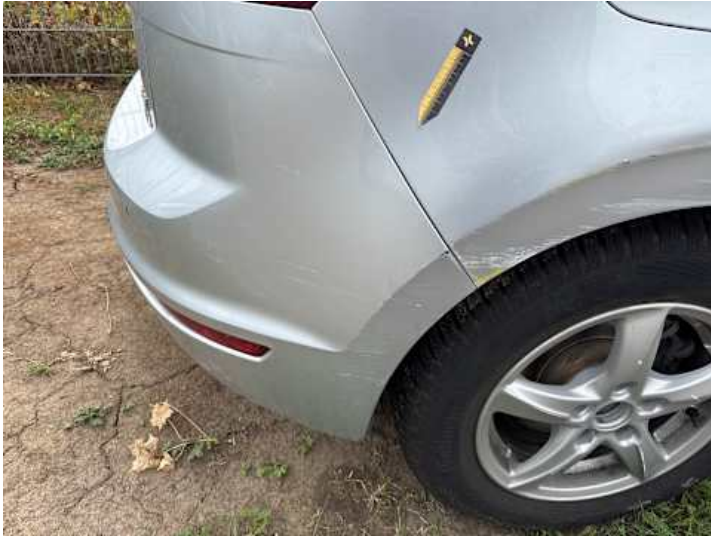
Stoßstange hinten (Lackschaden, Kratzer, Spaltmaße ungenau)
