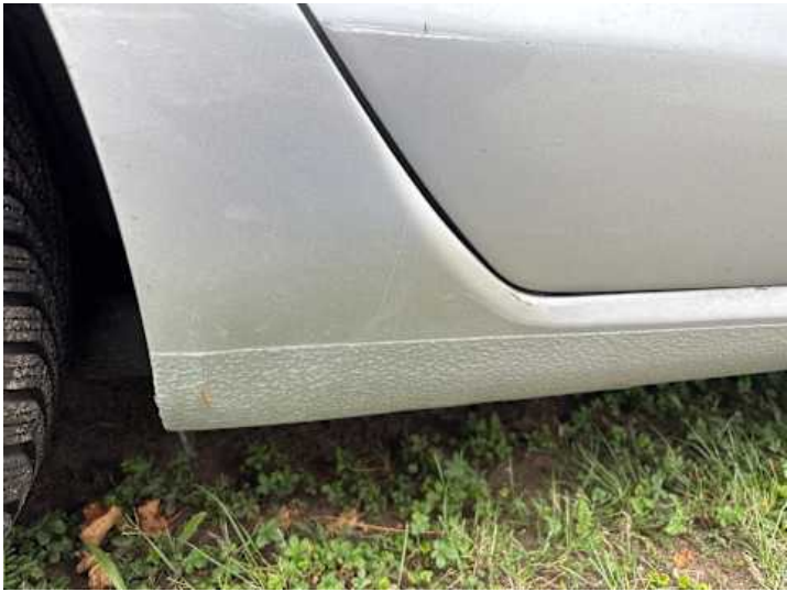
Schweller rechts (Rost, Unsachgemäß instand gesetzt)
