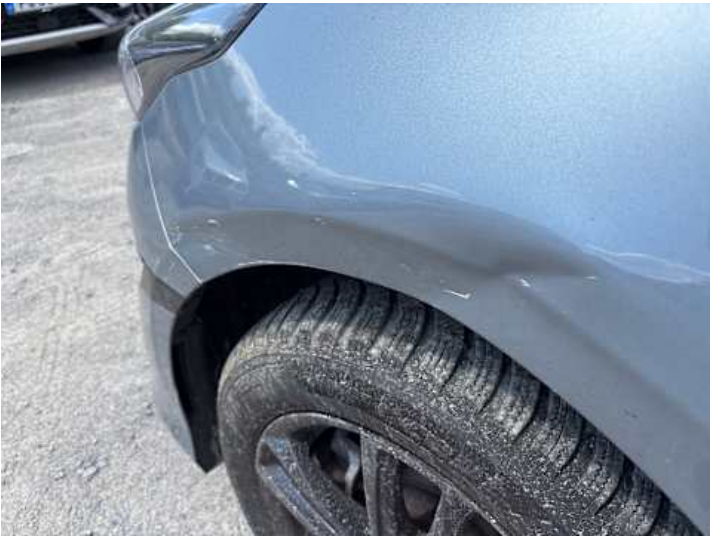
Kotflügel vorne links (Kratzer, Delle, Verformung)
