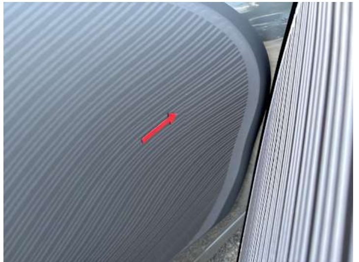
Türe hinten rechts (Verformung)
