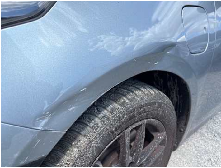
Kotflügel vorne links (Kratzer, Delle, Verformung)
