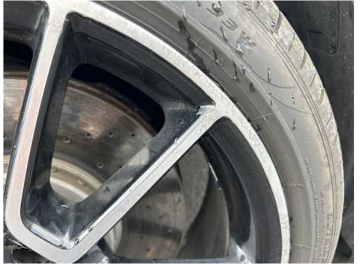
Rad (Anderer Schaden): Unsachgemäß Instandgesetzt
