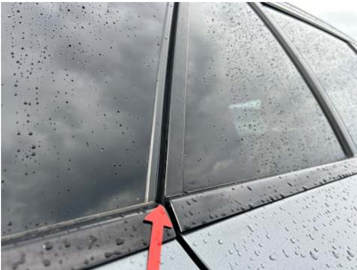
Türe hinten rechts (Spaltmaße ungenau)
