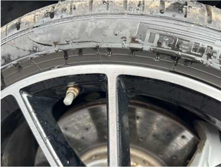
Rad (Anderer Schaden): Unsachgemäß Instandgesetzt
