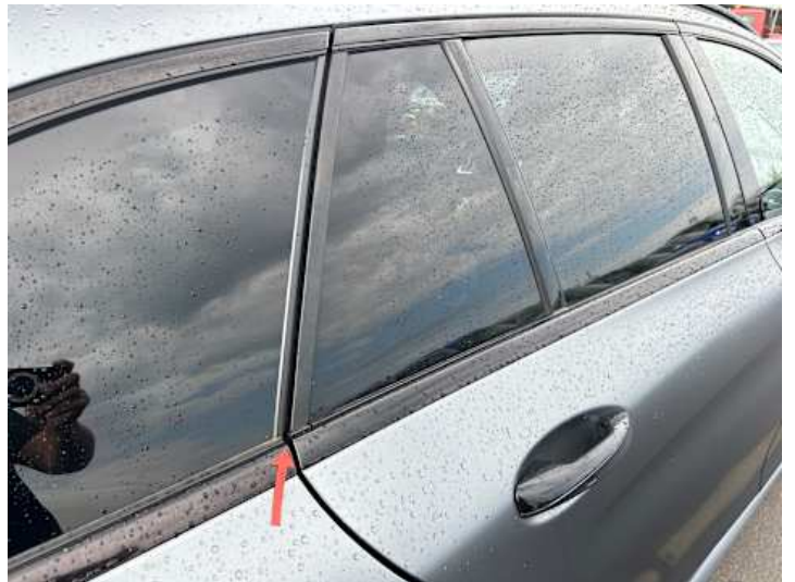
Türe hinten rechts (Spaltmaße ungenau)
