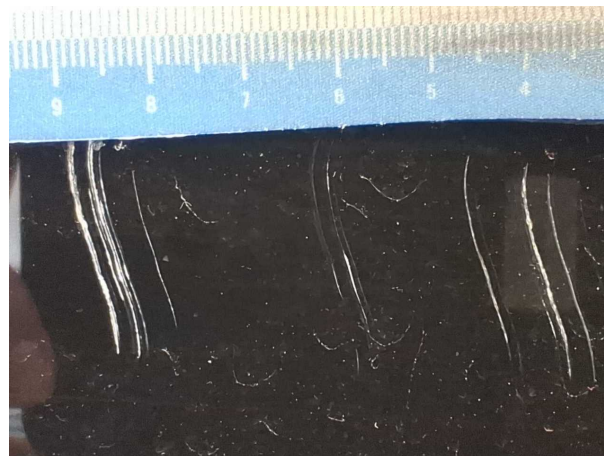
Beschädigung #1: Verglasung: Heckscheibe - verkratzt / verschürft - erneuern
