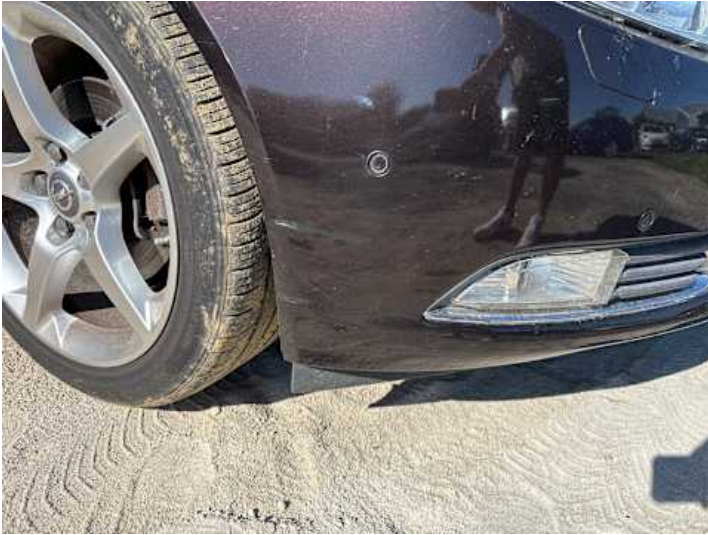
Stoßstange vorne (Riss/Bruch, Lackschaden)
