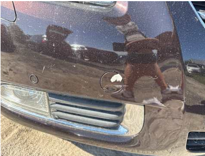
Stoßstange vorne (Riss/Bruch, Lackschaden)
