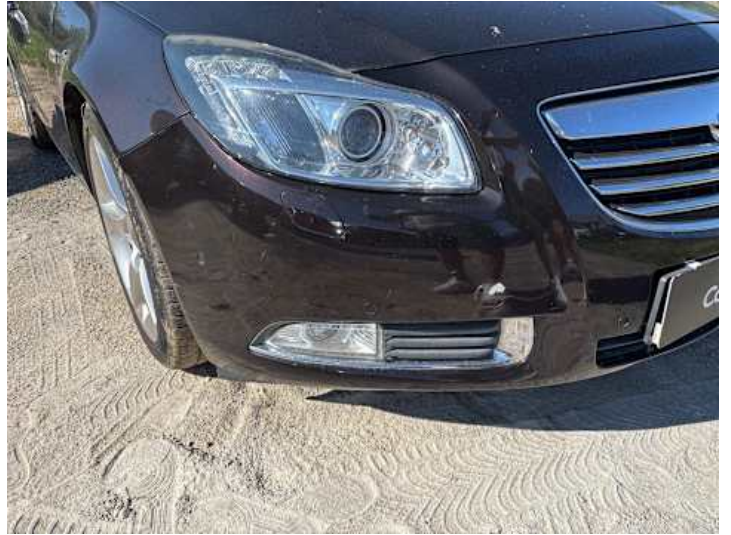
Stoßstange vorne (Riss/Bruch, Lackschaden)
