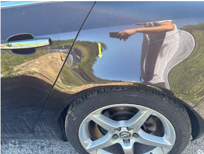
Seitenteil hinten links (Lackschaden)
