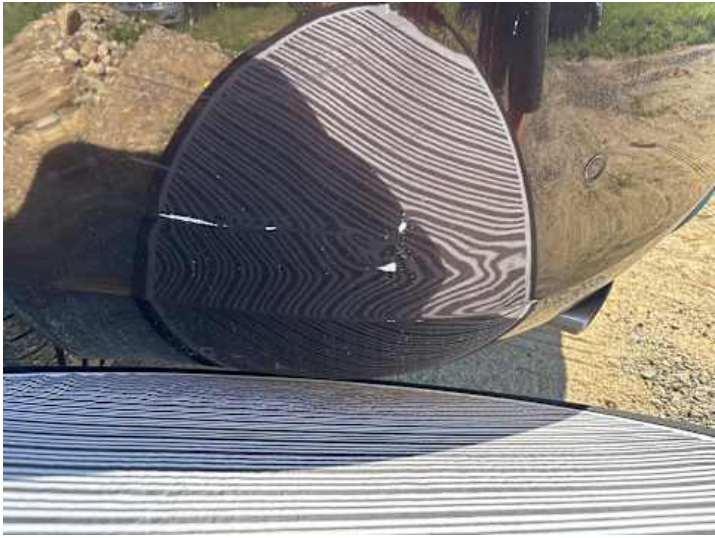
Stoßstange hinten (Kratzer, Lackschaden, Verformung)
