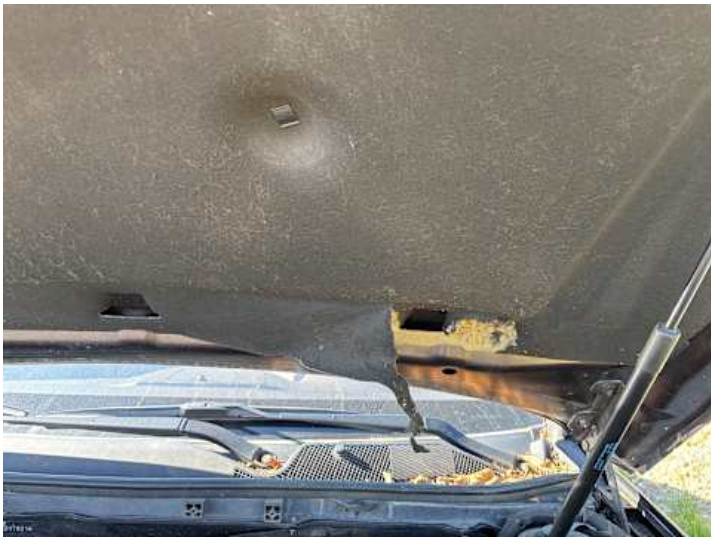
Motorhaube (Anderer Schaden): Marderspuren
