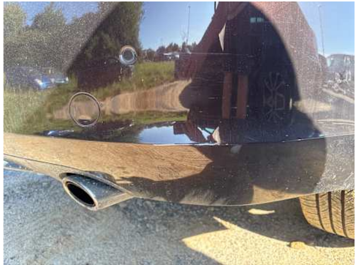
Stoßstange hinten (Kratzer, Lackschaden, Verformung)
