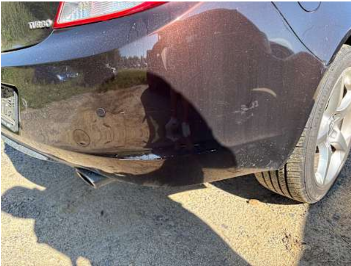
Stoßstange hinten (Kratzer, Lackschaden, Verformung)
