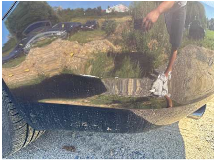
Stoßstange hinten (Kratzer, Lackschaden, Verformung)
