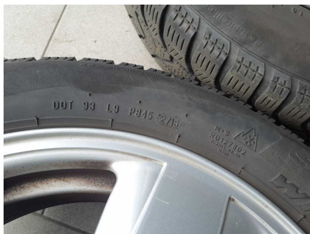
Beschädigung 8: 2.Radsatz: Reifensatz komplett (Dot 2716) - erneuern
