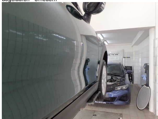
Beschädigung 5: Tür vorn rechts: Tür - Delle(n)
