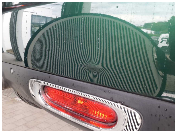
Beschädigung 6: Stossfänger hinten: Stossfänger hinten - verformt - erneuern
