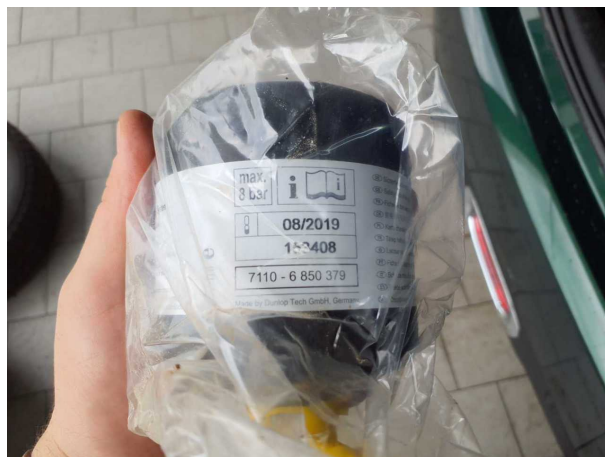
Beschädigung 3: Ausrüstung: Tirefit Füllmittel (08-19) - abgelaufen - erneuern
