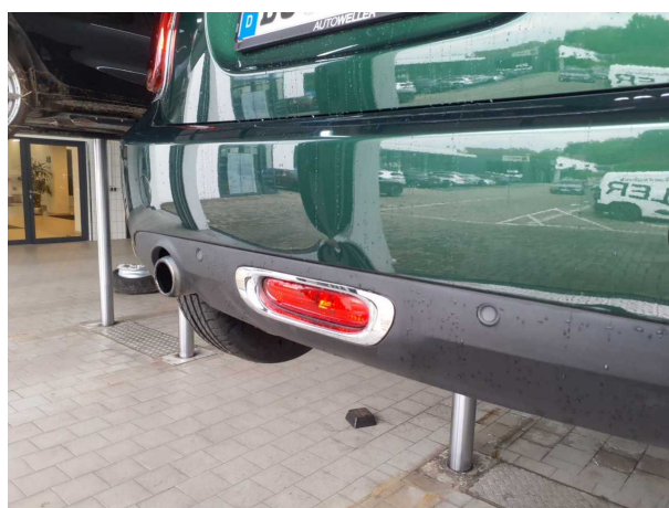
Beschädigung 6: Stossfänger hinten: Stossfänger hinten - verformt - erneuern
