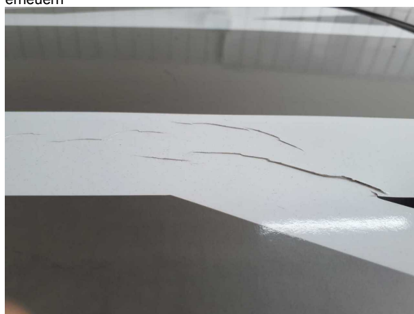
Beschädigung 9: Fahrzeugdach: Dach (Folierung) - de-/montieren
