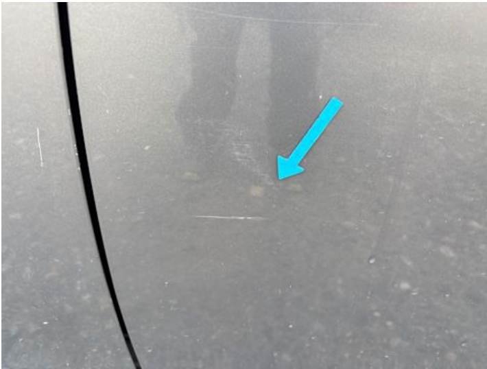
Türe hinten links (Kratzer)
