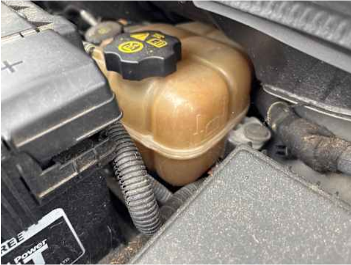
Motorhaube (Anderer Schaden): Kühlmittelstand zu gering,
