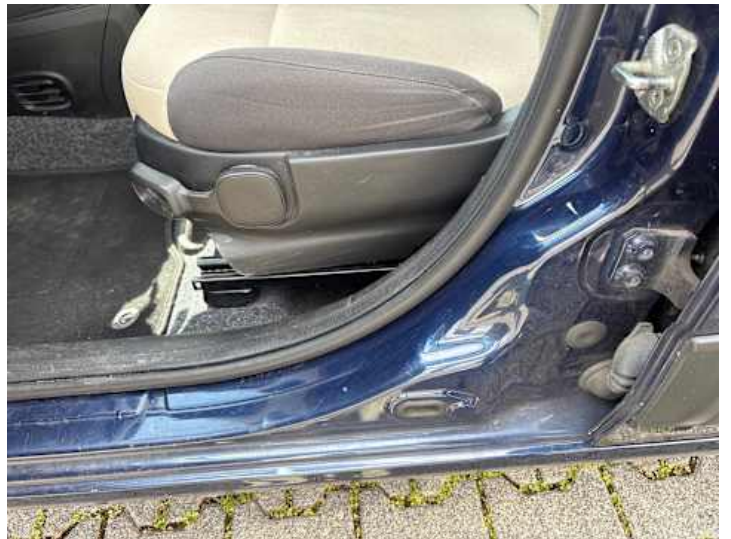
Fahrtür (Delle, Kratzer)
