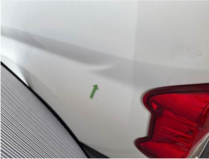
Seitenteil hinten links (Verformung, Delle)
