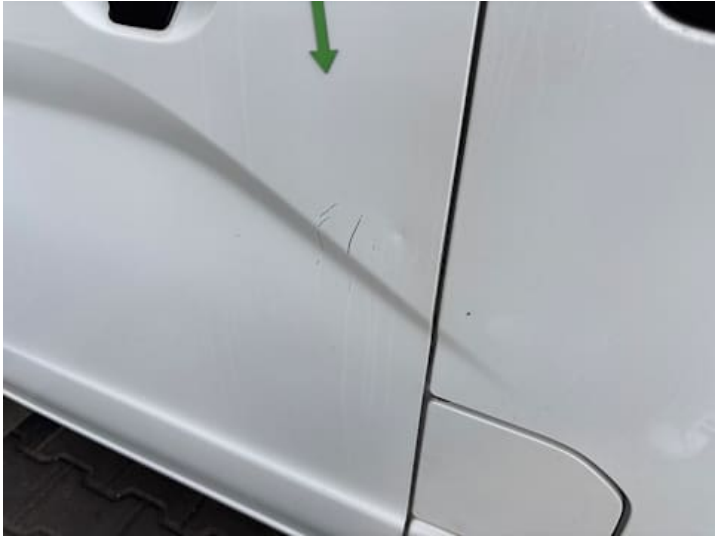
Türe hinten rechts (Kratzer, Delle)
