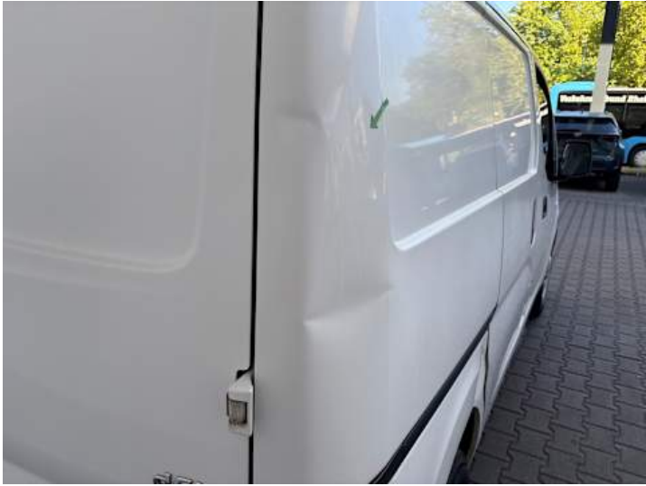
Seitenteil hinten rechts (Verformung)
