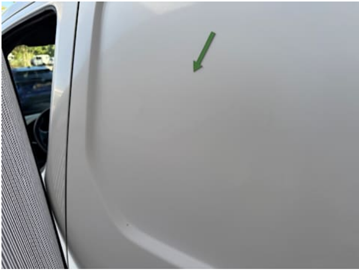
Seitenteil hinten links (Verformung, Delle)
