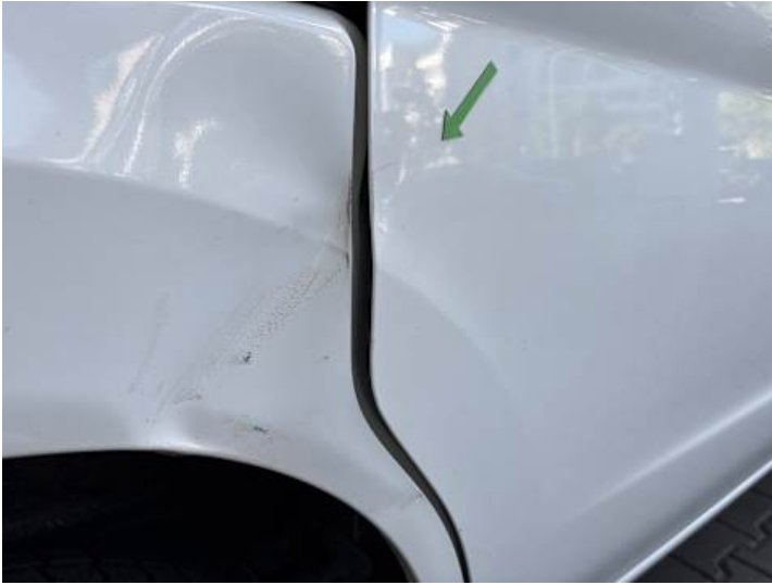
Türe hinten rechts (Kratzer, Delle)
