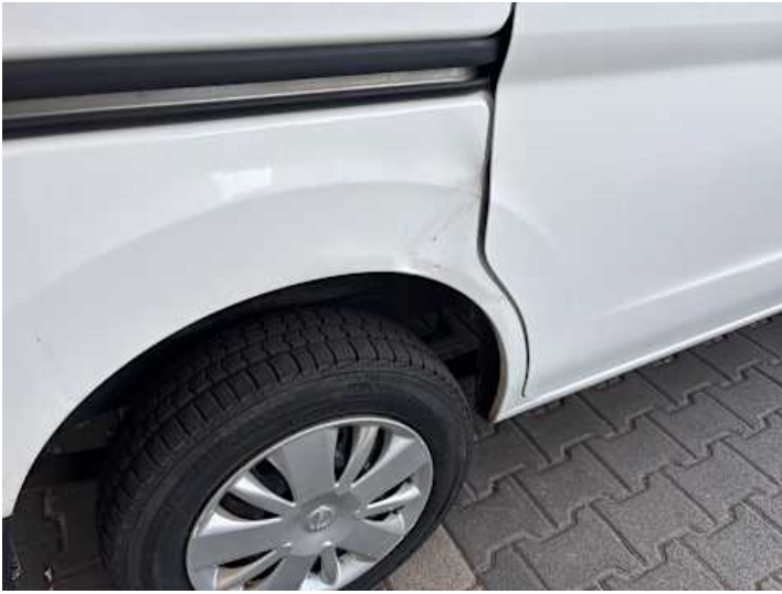
Seitenteil hinten rechts (Verformung)
