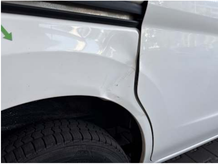
Seitenteil hinten rechts (Verformung)
