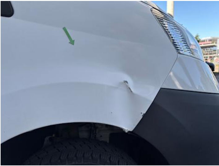
Kotflügel vorne rechts (Verformung)
