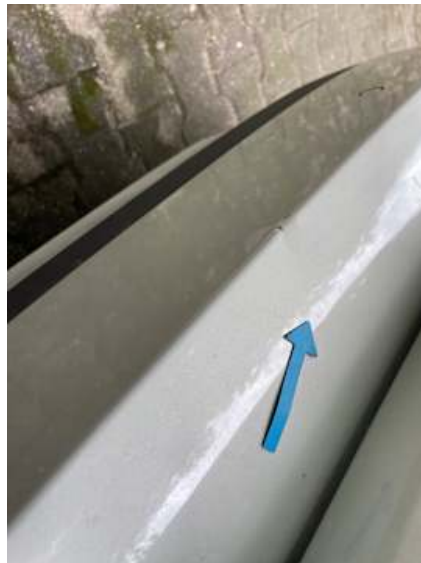
Stoßstange hinten (Kratzer, Verformung)
