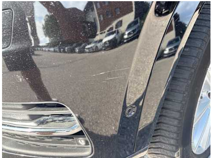
Stoßstange vorne (Kratzer, Lackschaden, Verformung)
