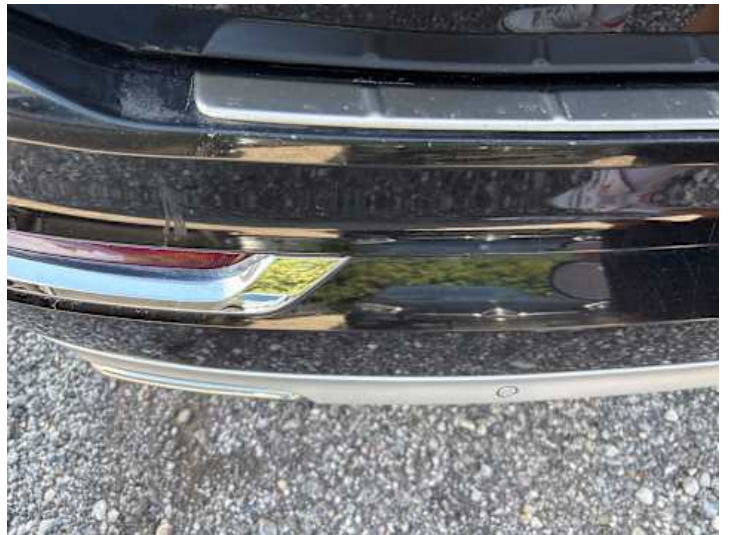
Stoßstange hinten (Kratzer, Lackschaden)
