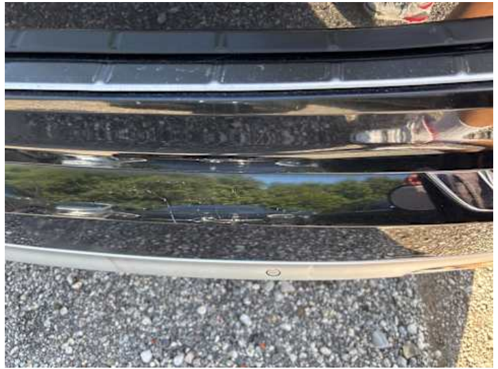
Stoßstange hinten (Kratzer, Lackschaden)
