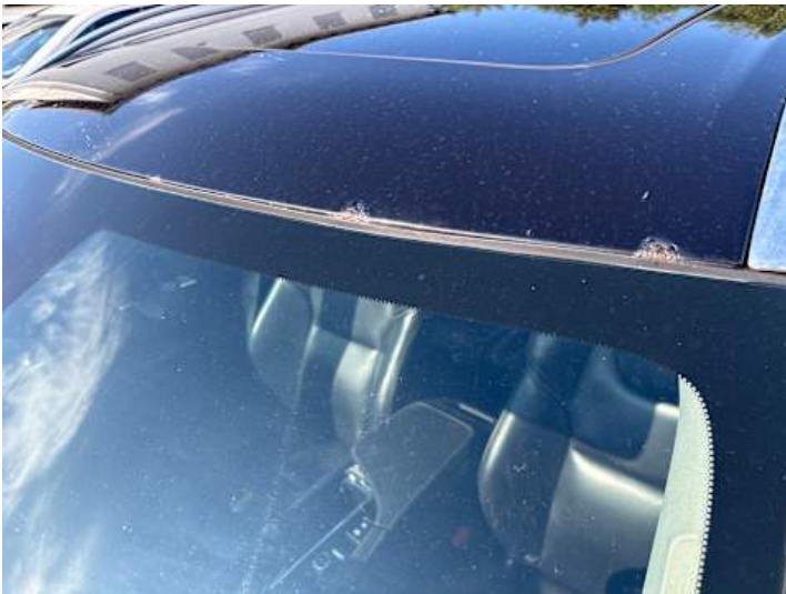
Dach (Rost, Lackschaden)
