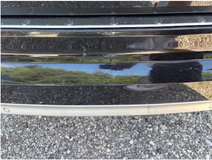
Stoßstange hinten (Kratzer, Lackschaden)
