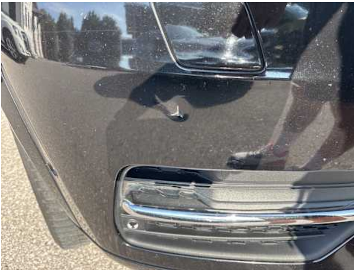
Stoßstange vorne (Kratzer, Lackschaden, Verformung)
