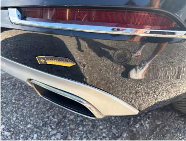
Stoßstange hinten (Lackschaden, Kratzer, Verformung)
