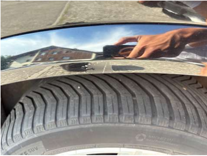
Seitenteil hinten links (Lackschaden)
