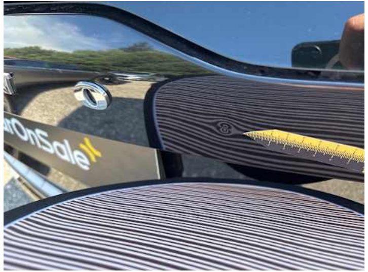
Heckklappe (Delle, Kratzer, Lackschaden)
