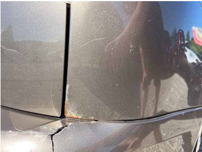
Seitenteil hinten rechts (Rost, Lackschaden, Kratzer)
