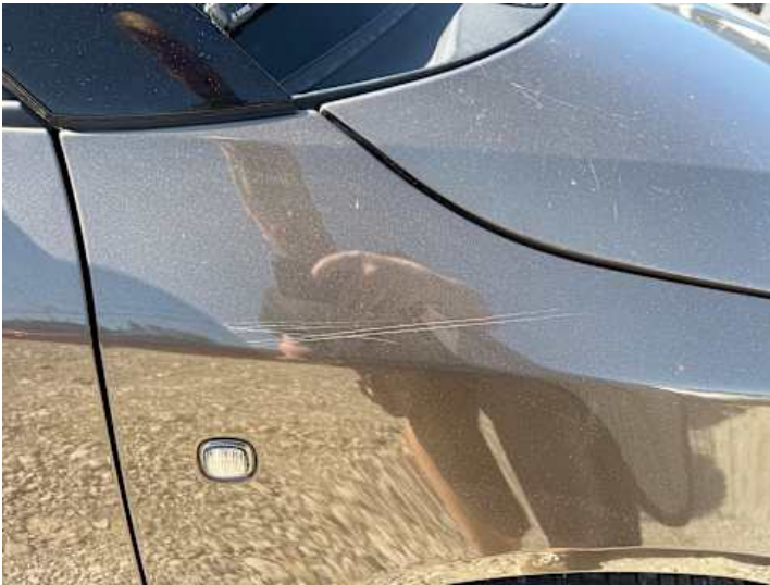
Kotflügel vorne rechts (Kratzer, Lackschaden)
