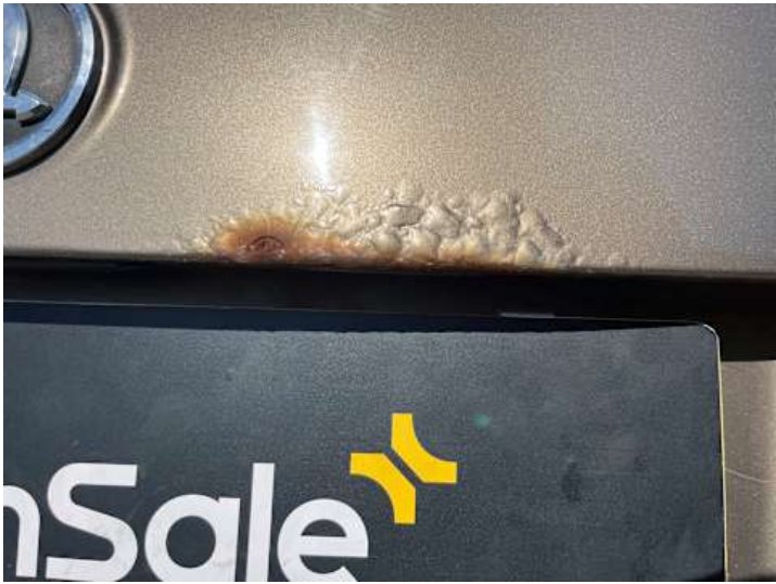
Heckklappe (Rost, Lackschaden, Kratzer, Delle)
