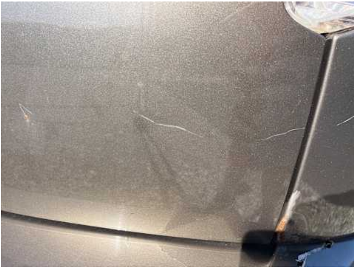
Heckklappe (Rost, Lackschaden, Kratzer, Delle)
