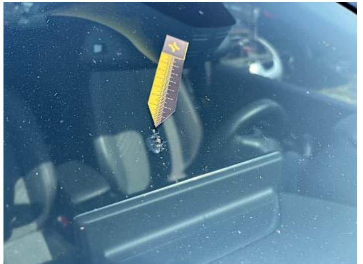
Windschutzscheibe (Steinschlag, Riss/Bruch)
