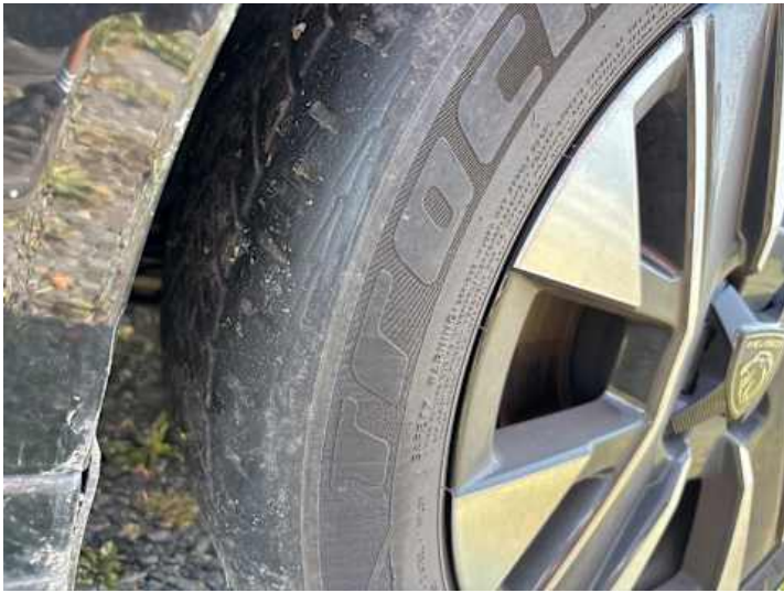
Rad (Ungleichmäßig abgefahren)
