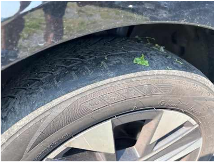
Rad (Ungleichmäßig abgefahren)
