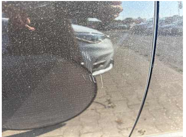
Türe hinten rechts (Delle, Kratzer)
