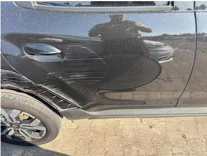
Türe hinten rechts (Delle, Kratzer)
