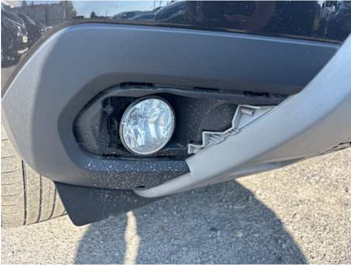
Stoßstange vorne (Anderer Schaden): Blende fehlt,
