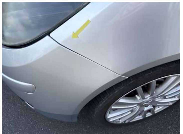
Stoßstange vorne (Spaltmaße ungenau)
