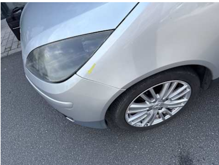
Stoßstange vorne (Spaltmaße ungenau)
