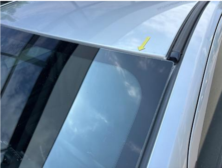
Windschutzscheibe (Anderer Schaden): Kleber löst sich
