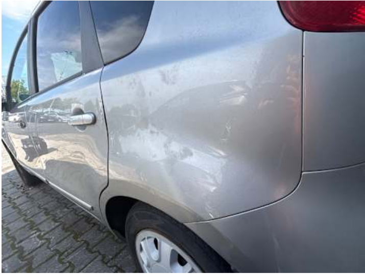
Seitenteil hinten links (Lackschaden)
