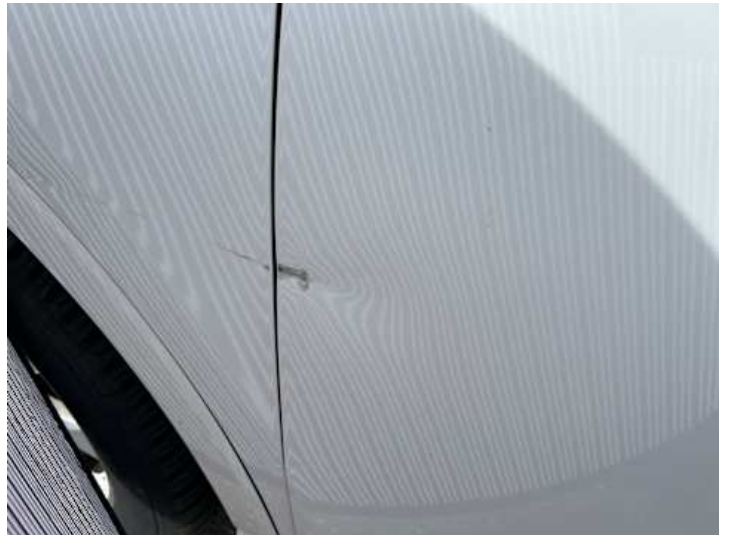
Fahrrertür (Kratzer, Verformung)
