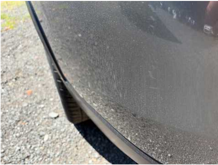
Stoßstange hinten (Kratzer, Verformung)
