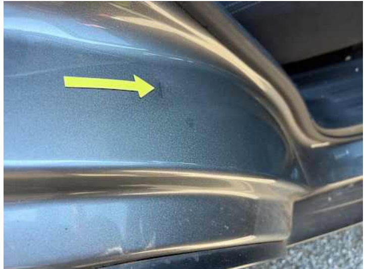
Schweller rechts (Kratzer, Delle)
