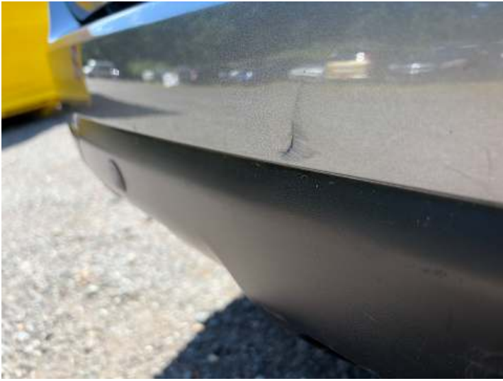
Stoßstange hinten (Kratzer, Verformung)
