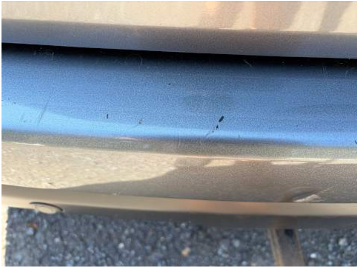
Stoßstange hinten (Kratzer, Verformung)
