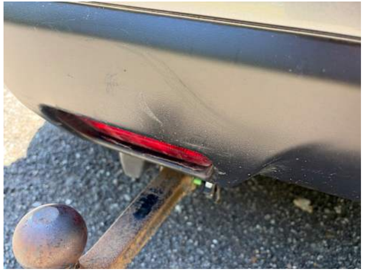
Stoßstange hinten (Kratzer, Verformung)
