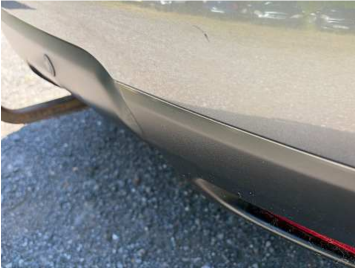
Stoßstange hinten (Kratzer, Verformung)
