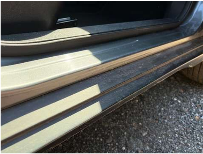
Schweller rechts (Kratzer, Delle)
