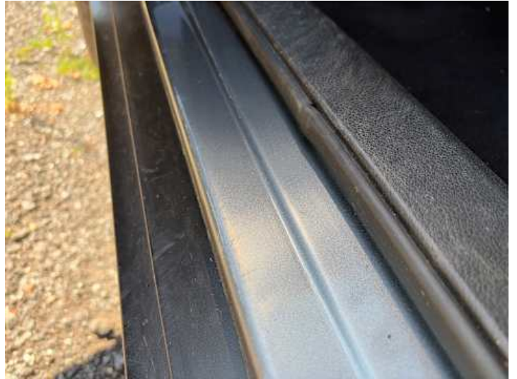
Schweller links (Lackschaden)
