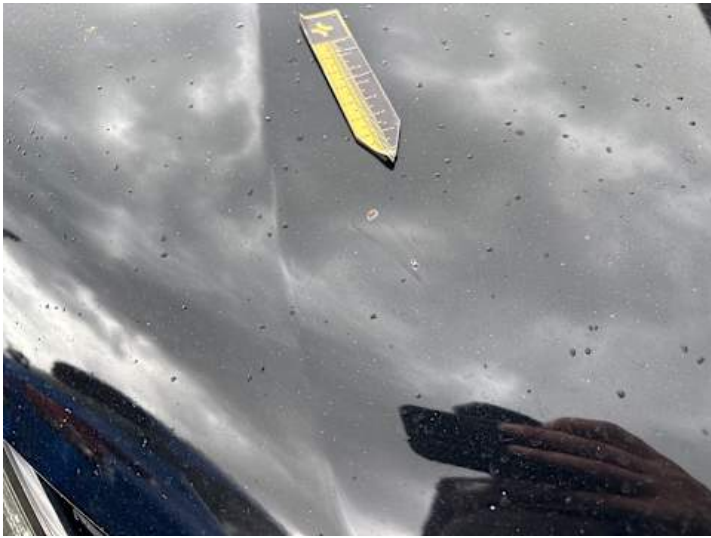
Motorhaube (Rost, Steinschlag)
