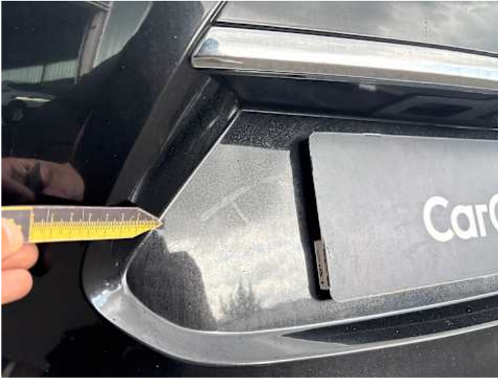
Heckklappe (Anderer Schaden): Motorenöl auf dem Lack
