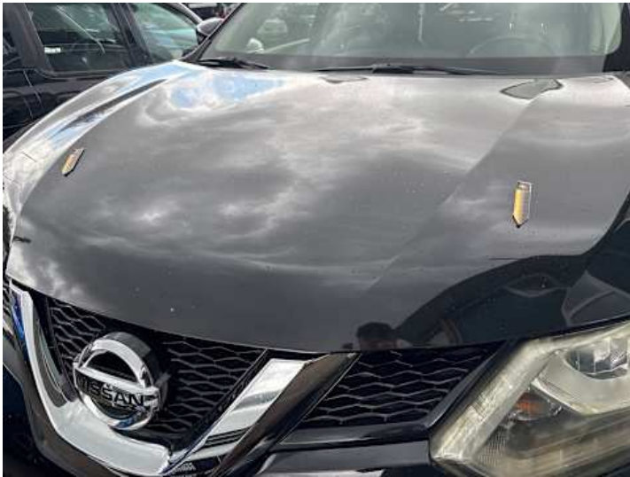
Motorhaube (Rost, Steinschlag)
