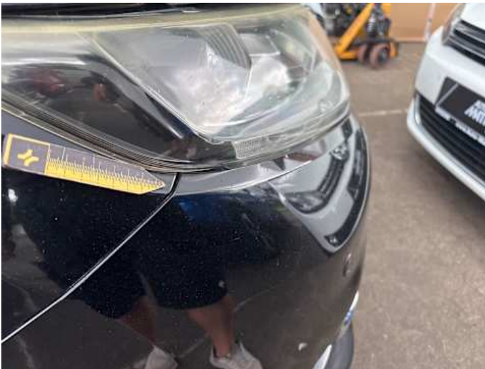
Stoßstange vorne (Spaltmaße ungenau)
