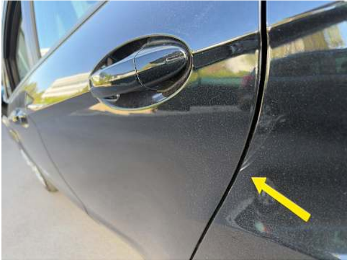
Seitenteil hinten links (Kratzer)
