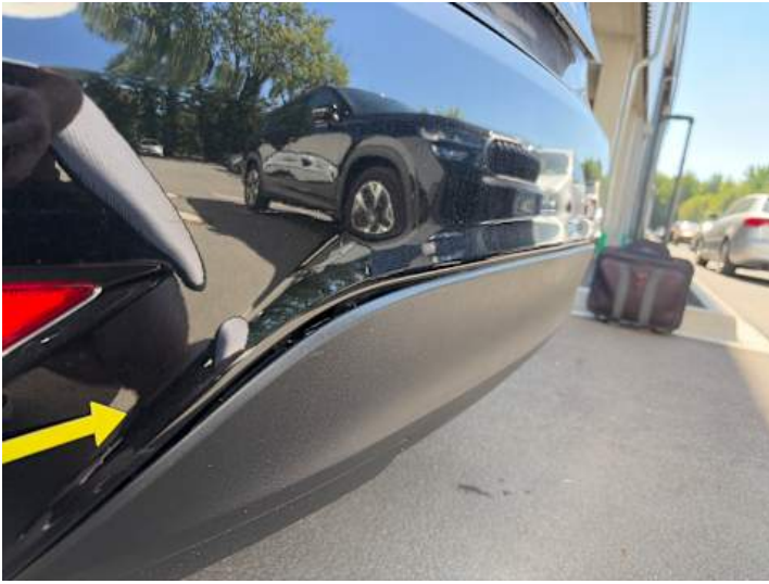
Stoßstange hinten (Spaltmaße ungenau, Riss/Bruch)
