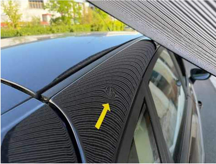
Dach (Delle, Kratzer)
