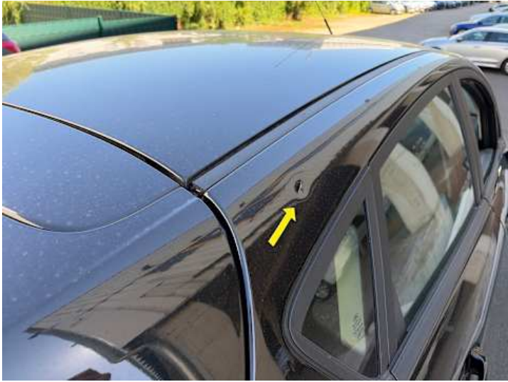
Dach (Delle, Kratzer)
