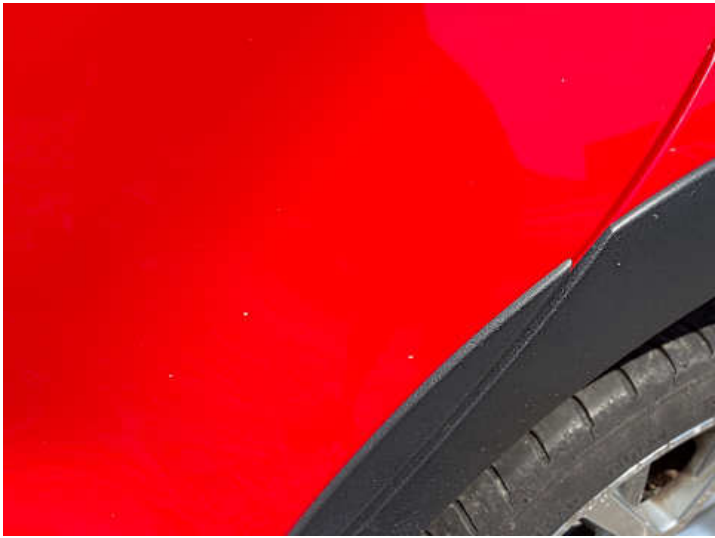
Türe hinten links (Steinschlag, Kratzer)
