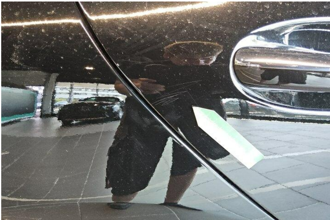
Bild 26 : Tür hinten rechts Lackierung, zerkratzt, lackieren
