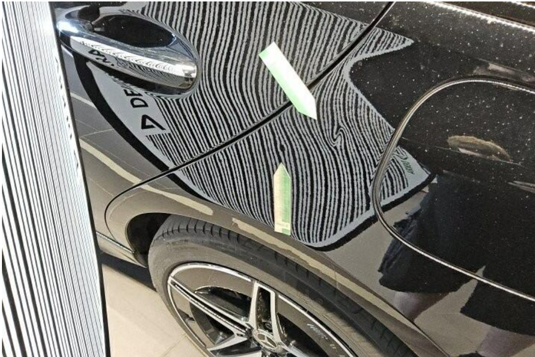
Bild 27 : Seitenteil hinten links, eingedellt, instandsetzen und lackieren mit Lackaufbau
