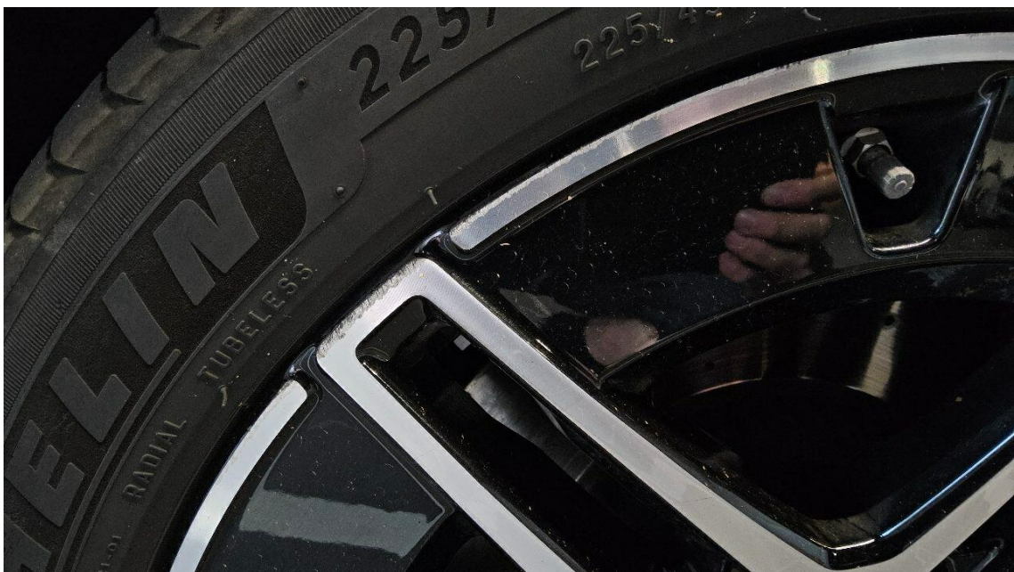
Bild 44 : Alufelge Glanzgedreht vorne links verschrammt
