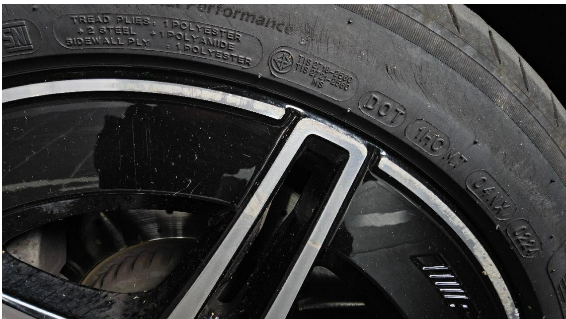
Bild 48 : Alufelge Glanzgedreht vorne rechts verschrammt
