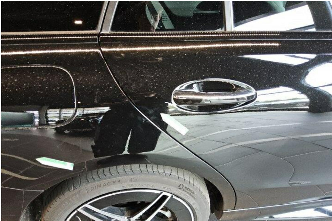
Bild 25 : Tür hinten rechts Lackierung, zerkratzt, lackieren
