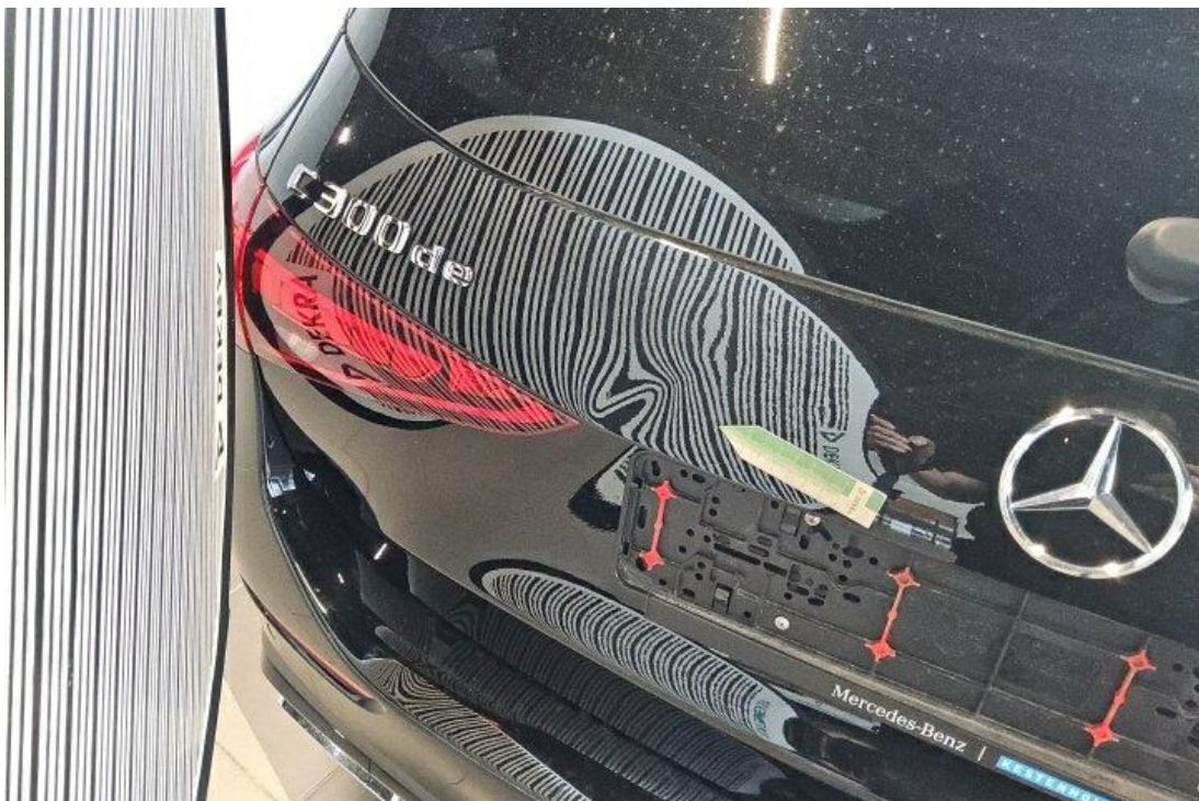
Bild 22 : Heckklappe, eingedellt, instandsetzen und lackieren mit Lackaufbau
