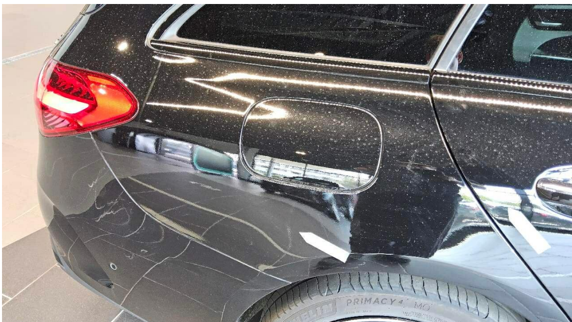
Bild 36 : Repariertter Seitenschaden rechts Lackbild nicht Sach und Fachgerecht, Minderwert
