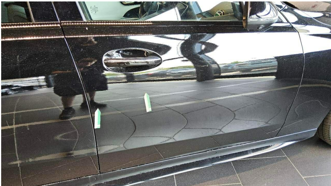
Bild 32 : Reparierter Seitenschaden rechts Lackbild nicht Sach und Fachgerecht, Minderwert
