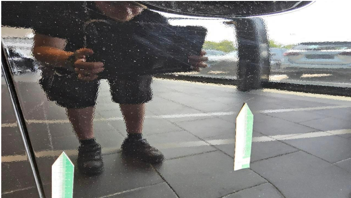
Bild 33 : Reparierter Seitenschaden rechts Lackbild nicht Sach und Fachgerecht, Minderwert
