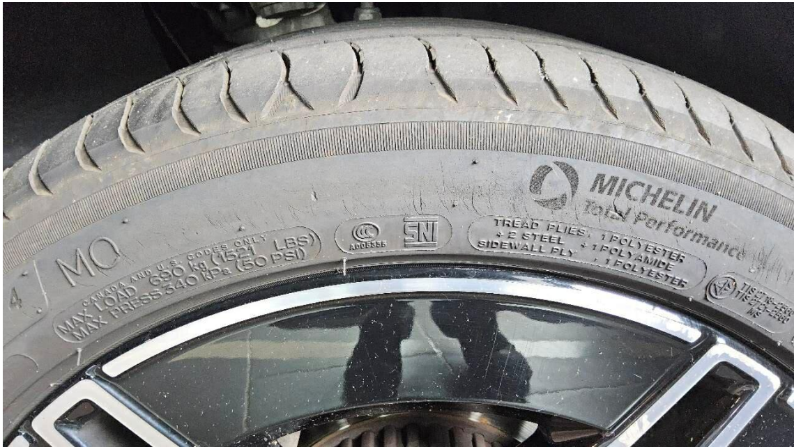
Bild 49 : Reifen vorne rechts eingerissen
