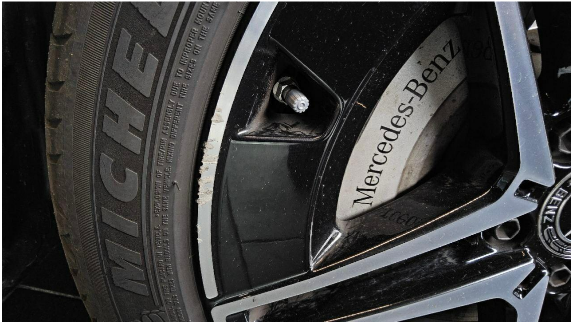
Bild 47 : Alufelge Glanzgedreht vorne rechts verschrammt
