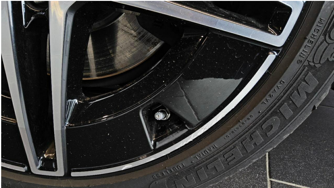
Bild 41 : Alufelge Glanzgedreht hinten rechts verschrammt
