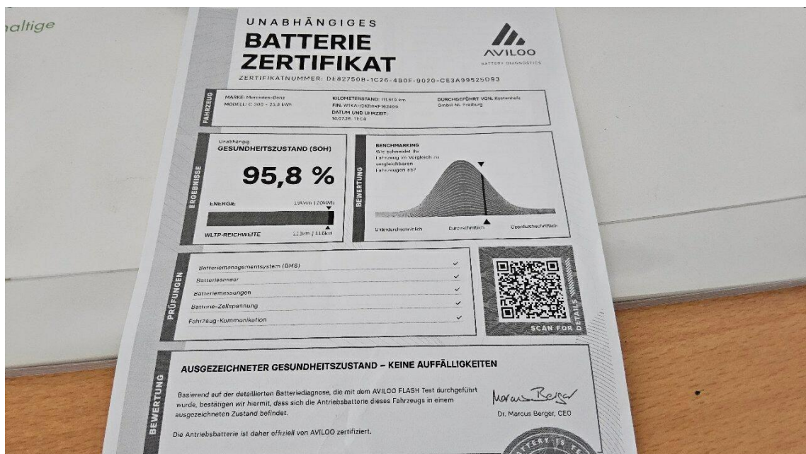
Bild 12 : ggf. SoH (State of Health): aktueller Gesundheitszustand der HV-Batterie
