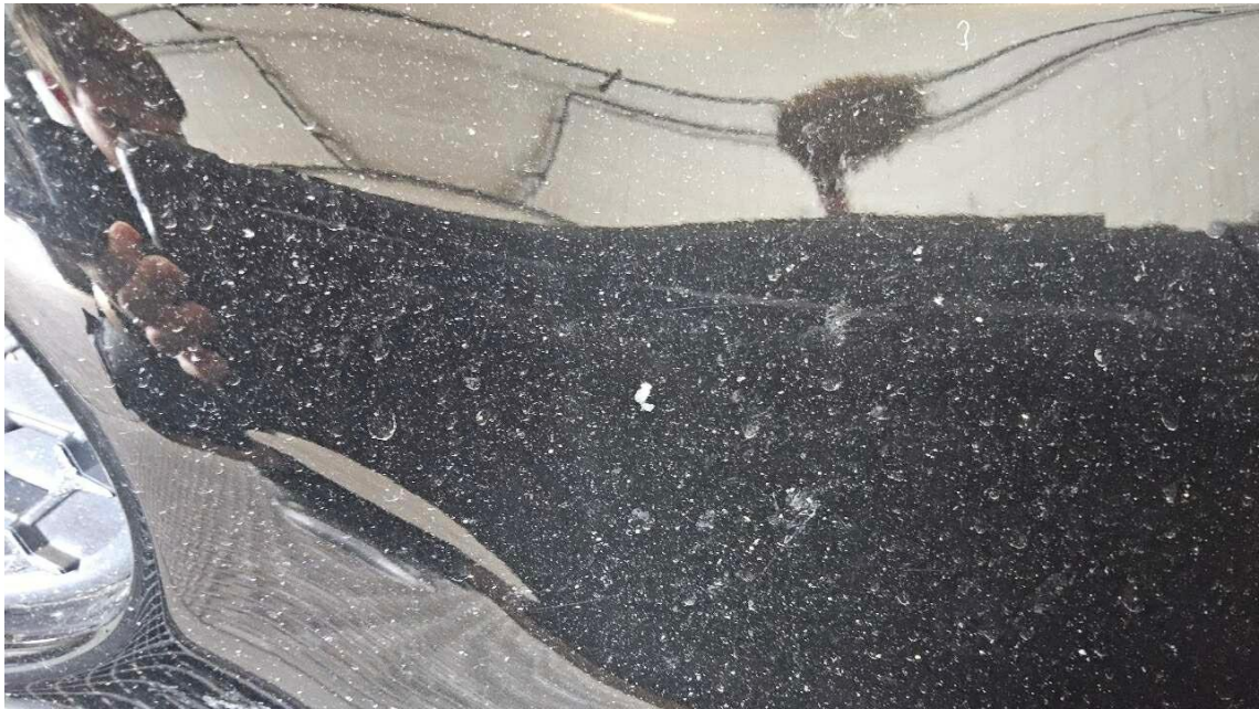
Bild 17 : Stoßfänger vorne Lackierung, viele Steinschläge, lackieren mit Lackaufbau
