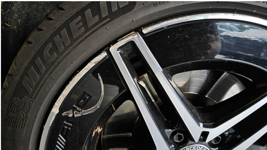
Bild 40 : Alufelge Glanzgedreht hinten rechts verschrammt
