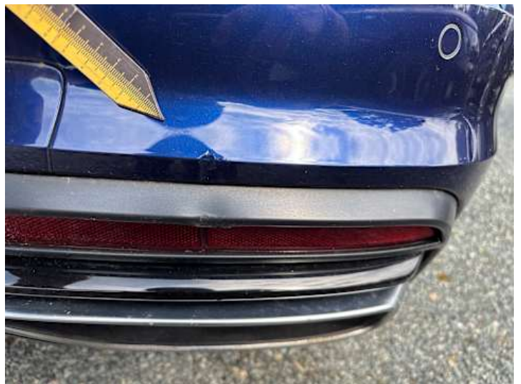
Stoßstange hinten (Kratzer, Delle)
