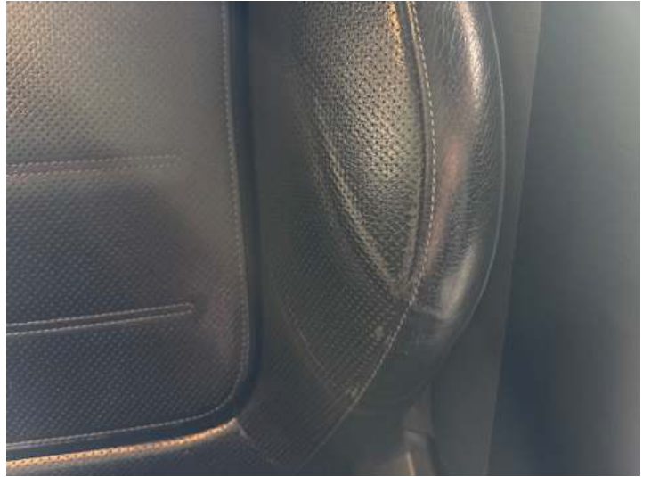
Innenraum (Verschmutzung, Verschleiß)
