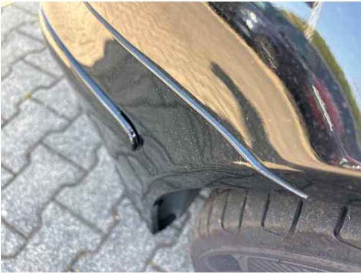
Stoßstange vorne (Anderer Schaden): Lose
