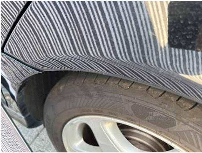
Seitenteil hinten links (Delle)
