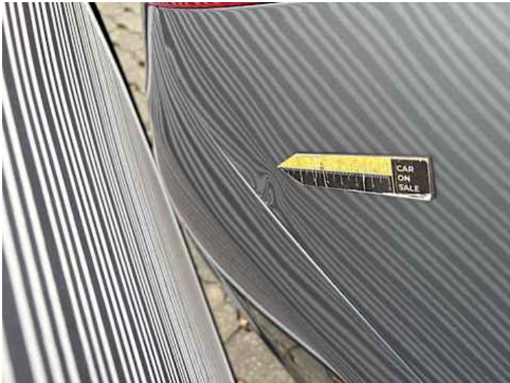
Seitenteil hinten rechts (Delle, Kratzer)
