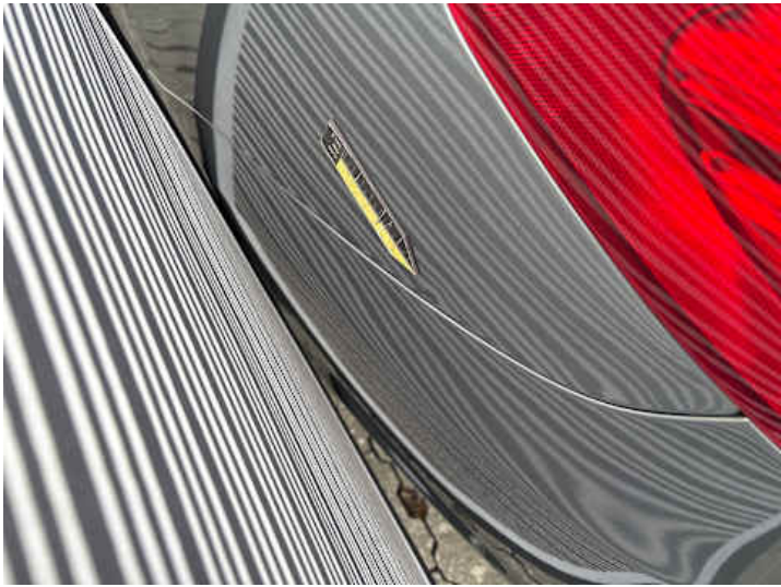
Seitenteil hinten links (Delle)
