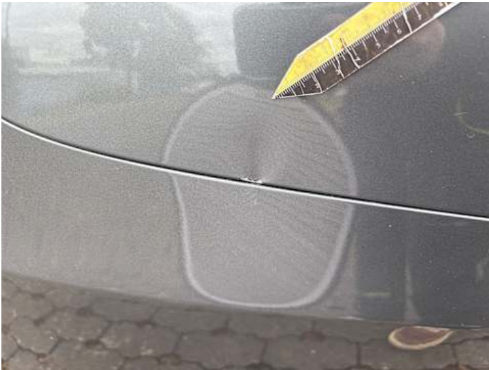
Seitenteil hinten rechts (Delle, Kratzer)
