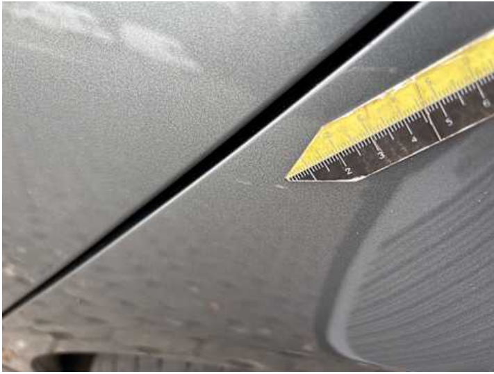
Seitenteil hinten links (Rost, Kratzer)
